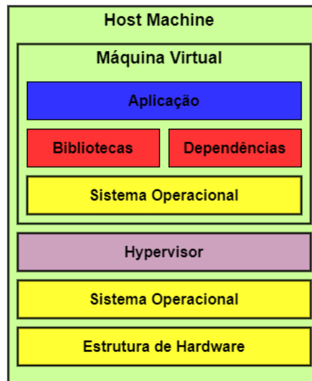
Figura 12 - Arquitetura de uma máquina virtual
