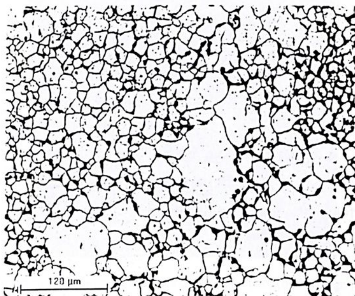
Figura 4.24 – Fotomicrografia ótica, inclusões agrupadas em contornos de grão. Ácido nítrico 60%, 1,5V - Aço ISO 5832-9 recozido 900°C/24h.
