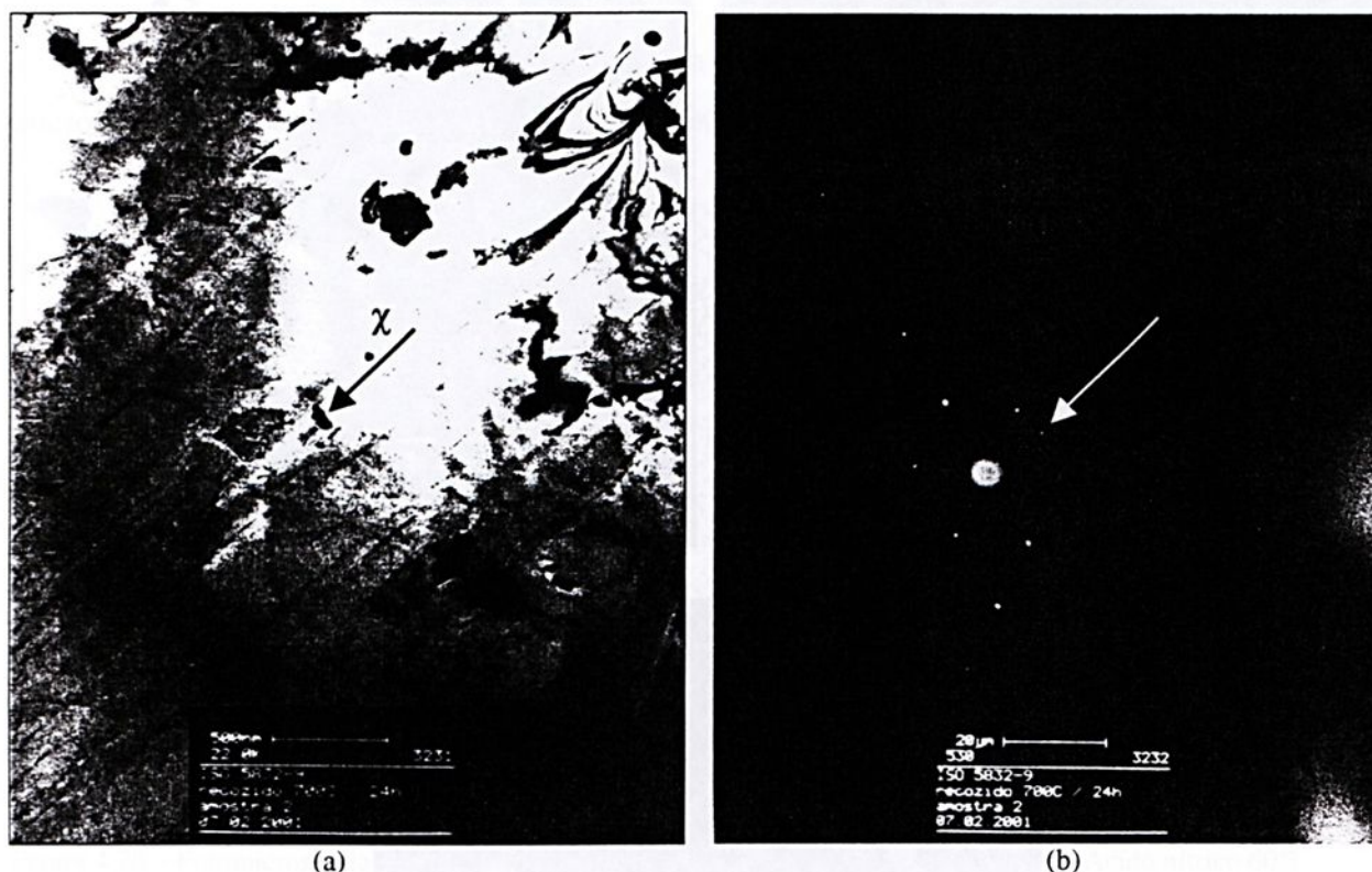
Figura 4.18 – (a) Fotomicrografia eletrônica de transmissão, campo claro; (b) difratograma da fase de baixa intensidade presente no centro de (a), identificada como fase \chi . Lâmina fina - Aço ISO 5832-9 recozido 700°C/24h.
