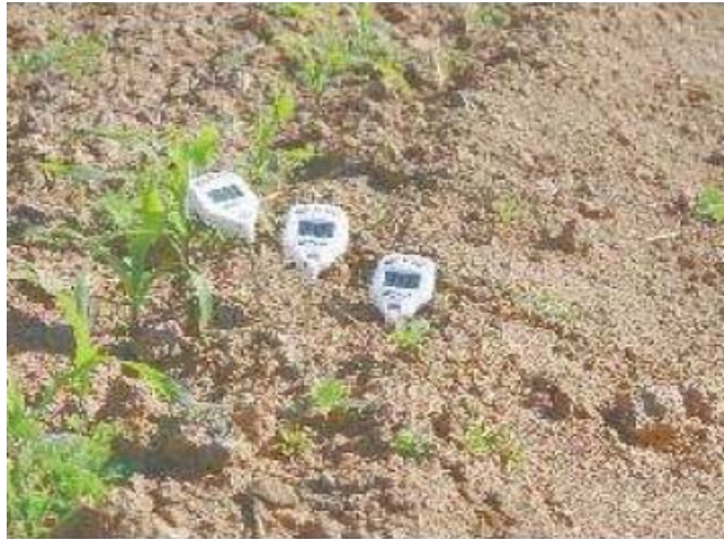
Figura 8: Termômetros utilizados para medir a temperatura do solo
