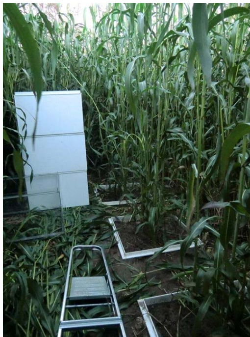
Figura 6: Uso de extensões para a medição dos gases do efeito estufa.
