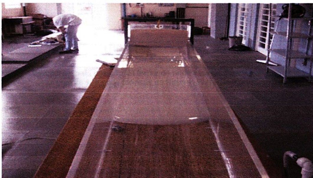
Figura 36 - Vista frontal do ensaio com a mistura água + argila caulinítica.
