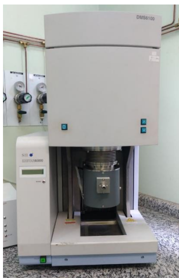
Figura 21 – Equipamento de DMA da SEIKO, modelo DMS 6100.
