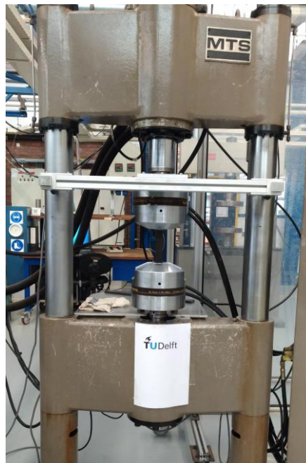
Figura 29 – Máquina de Fadiga MTS 100 kN
