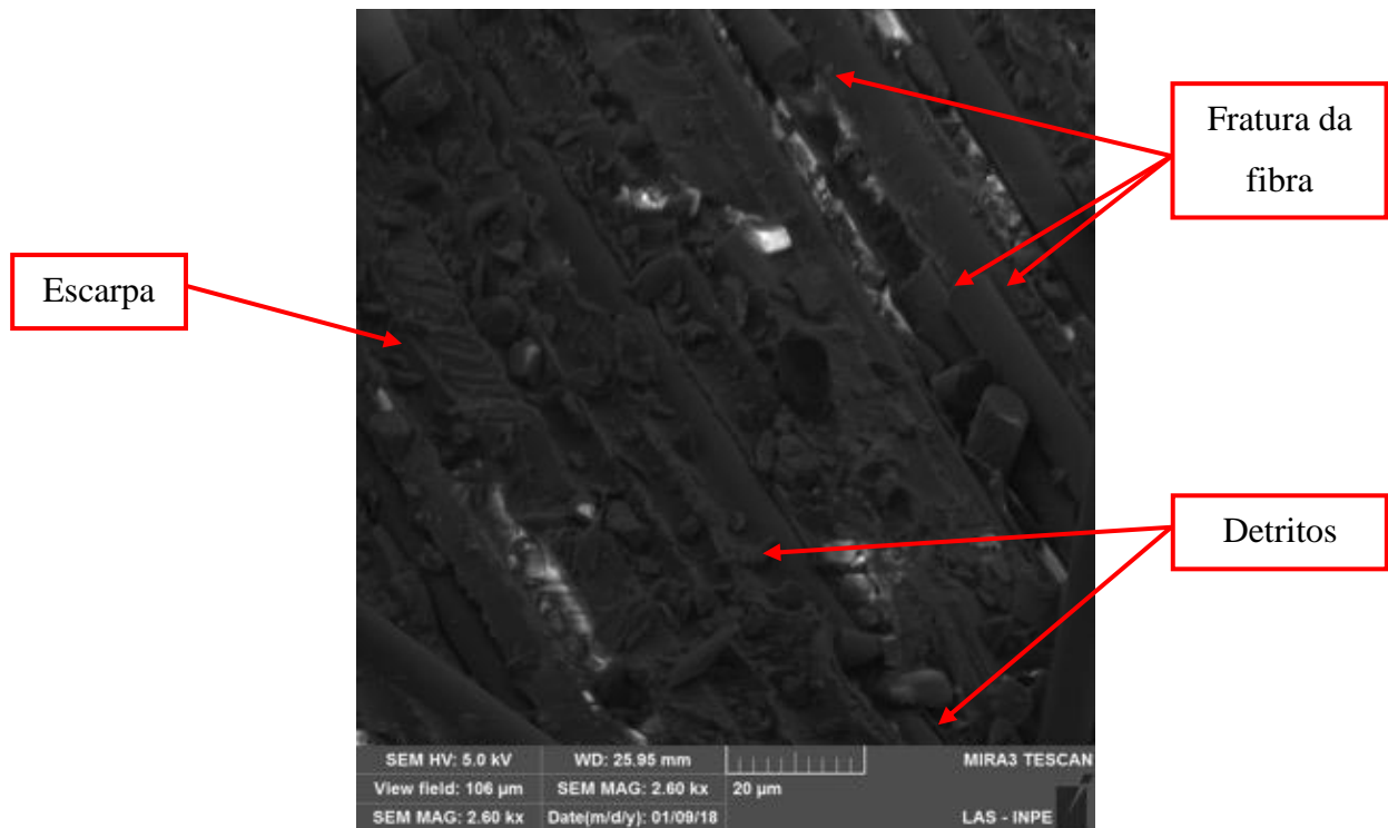
Figura 56 - Micrografia da região da fratura do CDP PEI/FC submetido a fadiga em temperatura elevada.
