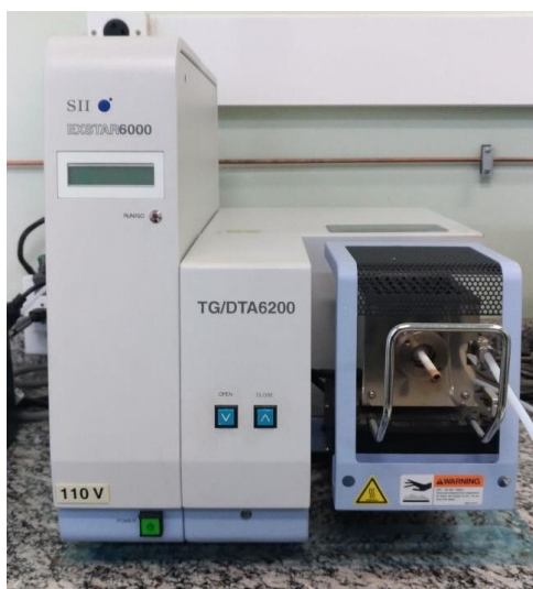
Figura 20 – Equipamento TGA da SEIKO, modelo TG/DTA 6200.
