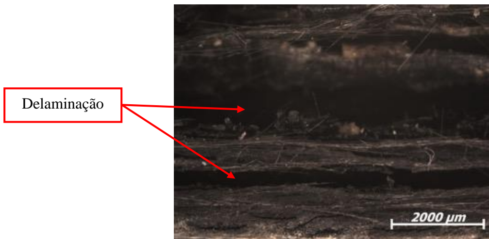
Figura 52 – Estereoscopia da região da fratura do CDP de PEI/FC submetido a fadiga em temperatura ambiente.
