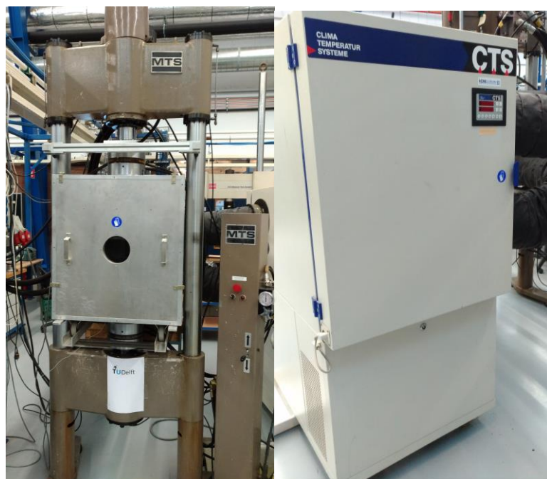
Figura 31 - Configuração do ensaio de fadiga para temperaturas sub-ambiente e elevada
