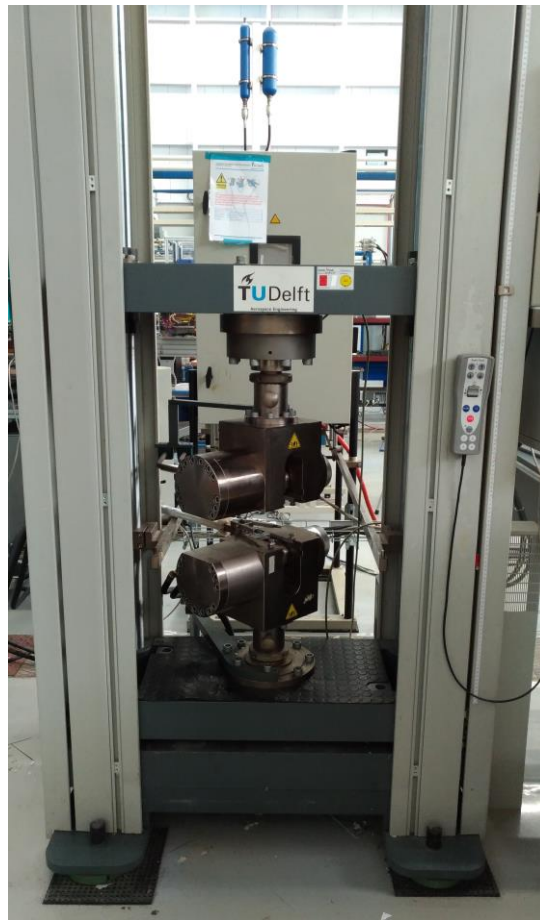
Figura 28 – Máquina universal ZWICK Z250 utilizada para realização do ensaio de tração
