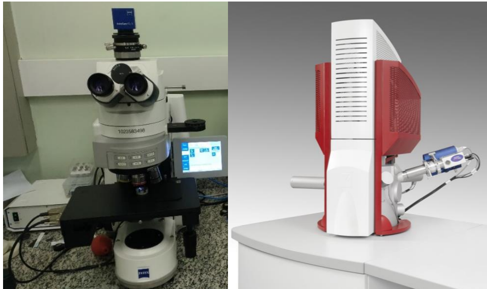
Figura 33 – (a) MO da marca Zeiss, modelo AxioImager Z2m (b) MEV-FEG da marca Tescan, modelo Mira 3.
