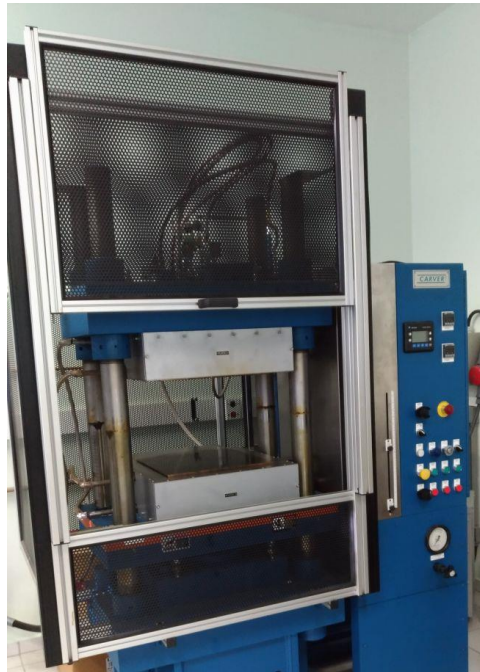
Figura 23 – Prensa da marca Carver e modelo CMV100H-15-X utilizada.
