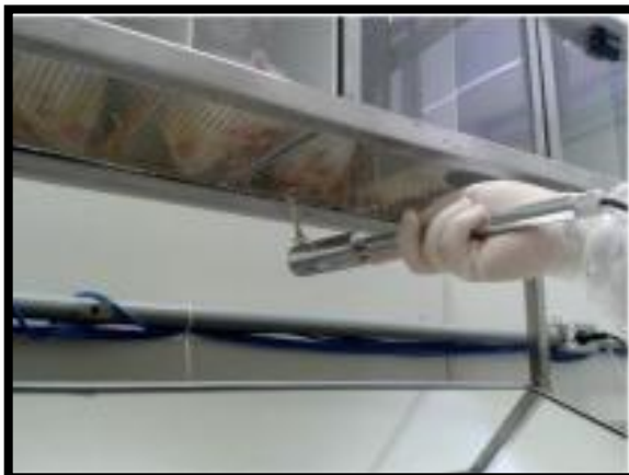
Figura 16: Braço do aparelho von Frey eletrônico aferindo a hiperalgesia (dor) na pata traseira direita de ratos.
