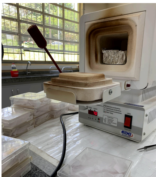
Figura 4 – Preparação para o choque térmico das sementes em mufla a 70°C por 5 minutos.
