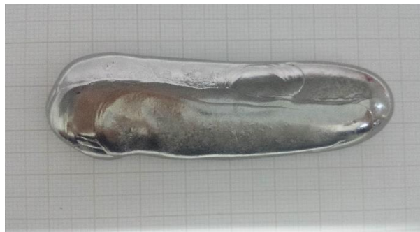
Figura 12: Lingote da liga Ti-40Nb produzida neste trabalho.
