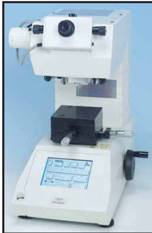
Figura 6. Microdurômetro Shimadzu (HMT-2T, Shimadzu Corp, Japão)
