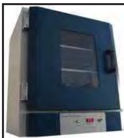
Figura 5. Estufa bacteriológica digital (CE-150/280I, CIENLAB Equipamentos Científicos Ltda., Campinas, São Paulo, Brasil).
