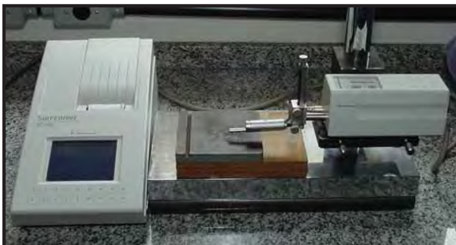
Figura 7. Rugosímetro Surf Corder (SE1700, Kosakalab, Tóquio, Japão)
