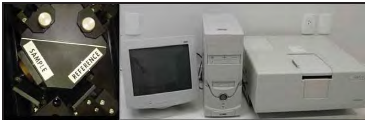
Figura 9. Espectrofotômetro de reflexão ultravioleta visível (UV-2450, Shimadzu Corp., Japão).
