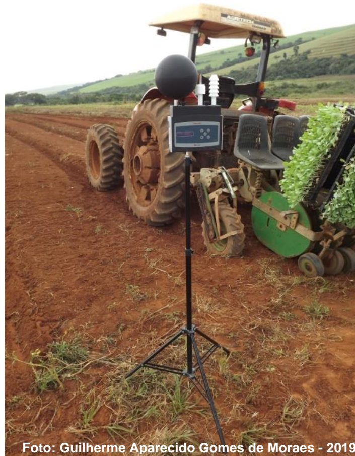
Figura 16 - Medidor IBUTG instalado em área de transplante mecanizado
