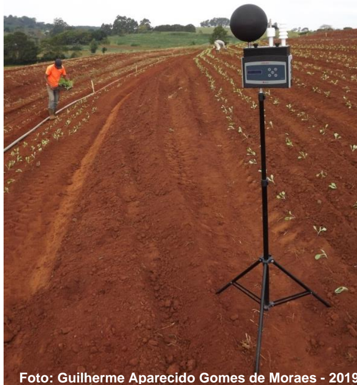
Figura 17 - Medidor IBUTG instalado em área de transplante manual
