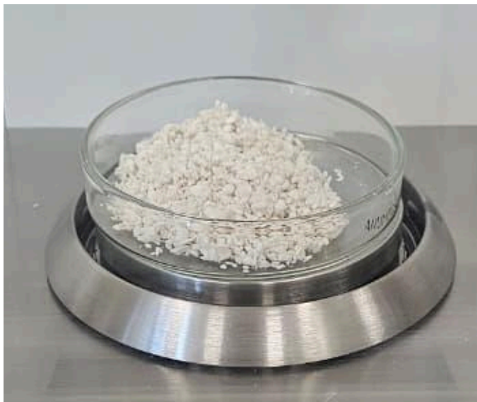
Figura 1 - Amostra de celulose utilizada para a obtenção do teor de umidade.
