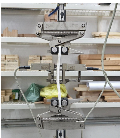
Figura 8 - Corpo de prova para ensaio de tração disposto na máquina de ensaio universal EMIC com extensômetro acoplado ao corpo de prova
