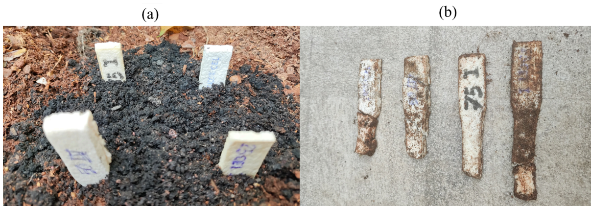
Figura 14 - Amostras durante teste de degradabilidade em solo: (a) recém enterrados e (b) após 2 semanas
