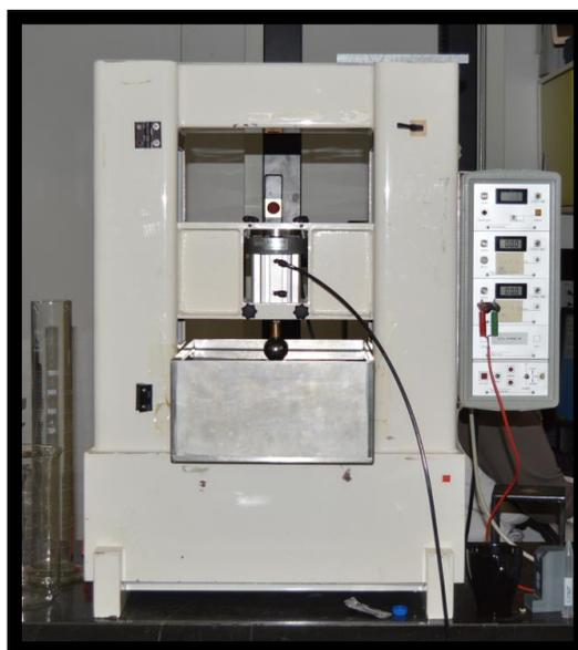
Figura 8 - Máquina em que se realizou o ensaio (*ACTA Fatigue Tester II*).
