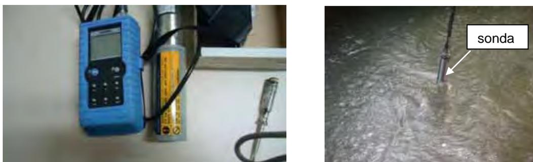
**Figura 5.** Sonda multiparamétrica HORIBA com sensores para monitoramento de qualidade da água em campo.
