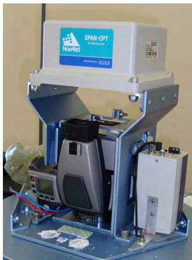
Figura 21: Receptor Novatel SPAN/CPT montado sobre sistema de câmaras.
