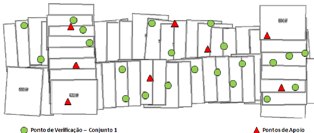
Figura 58: Disposição dos Pontos de apoio e verificação no bloco de imagens.
