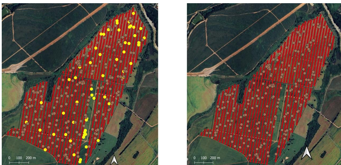
Figura 7. Os pontos em vermelho mostram medidas de CEa do solo, os círculos em marrom são buffers de 15 metros e na figura da esquerda os círculos amarelos são buffers que não possuem quatro pontos de CEa para compor a média.
