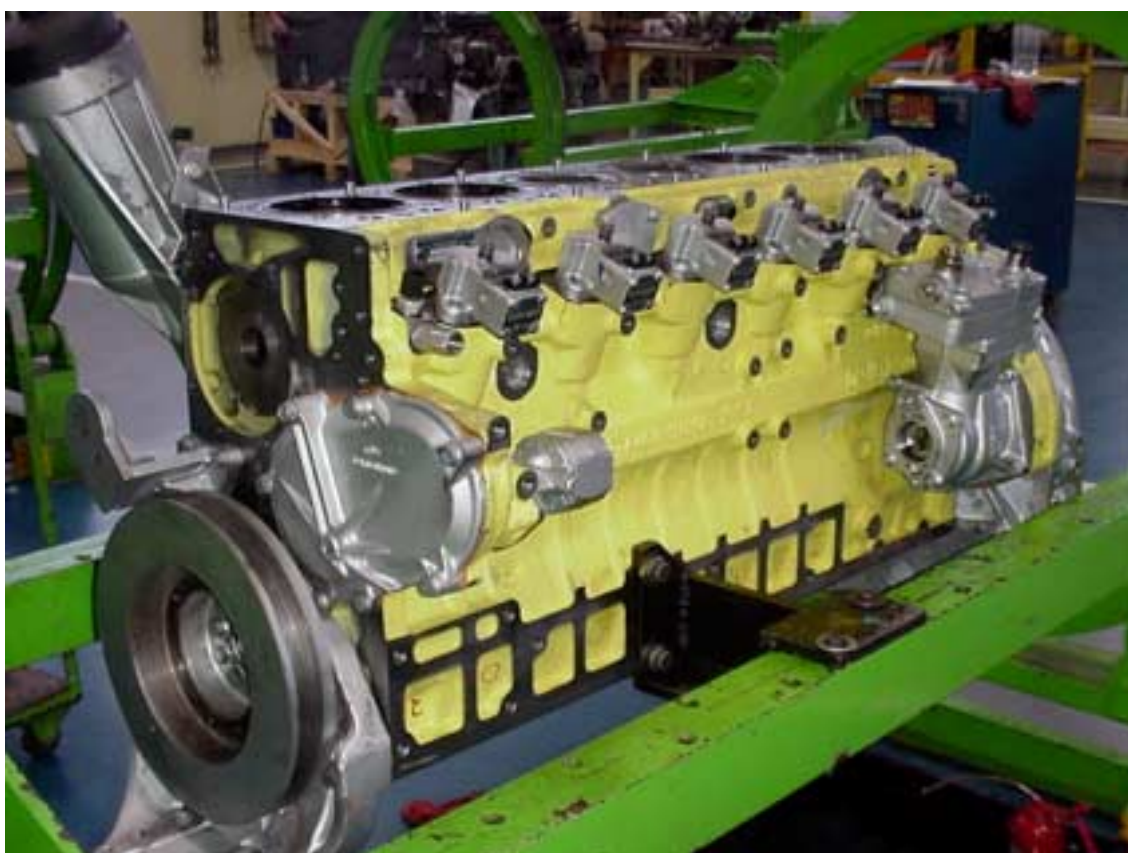
Figura 41 – Início da montagem de componentes do EGR no motor OM460LA EPA2004
