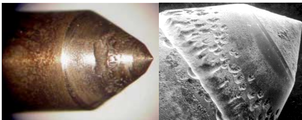
Figura 11 – Detalhe da agulha do injetor danificada pela presença de enxofre
