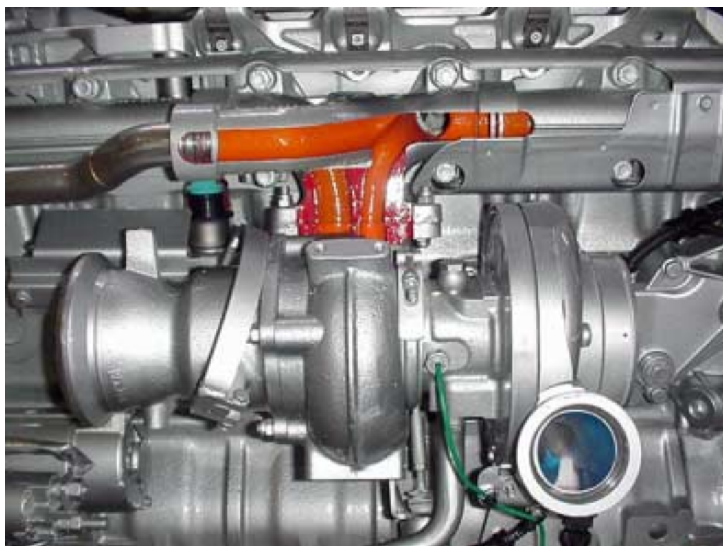
Figura 25 – Turbina Assimétrica em detalhes
