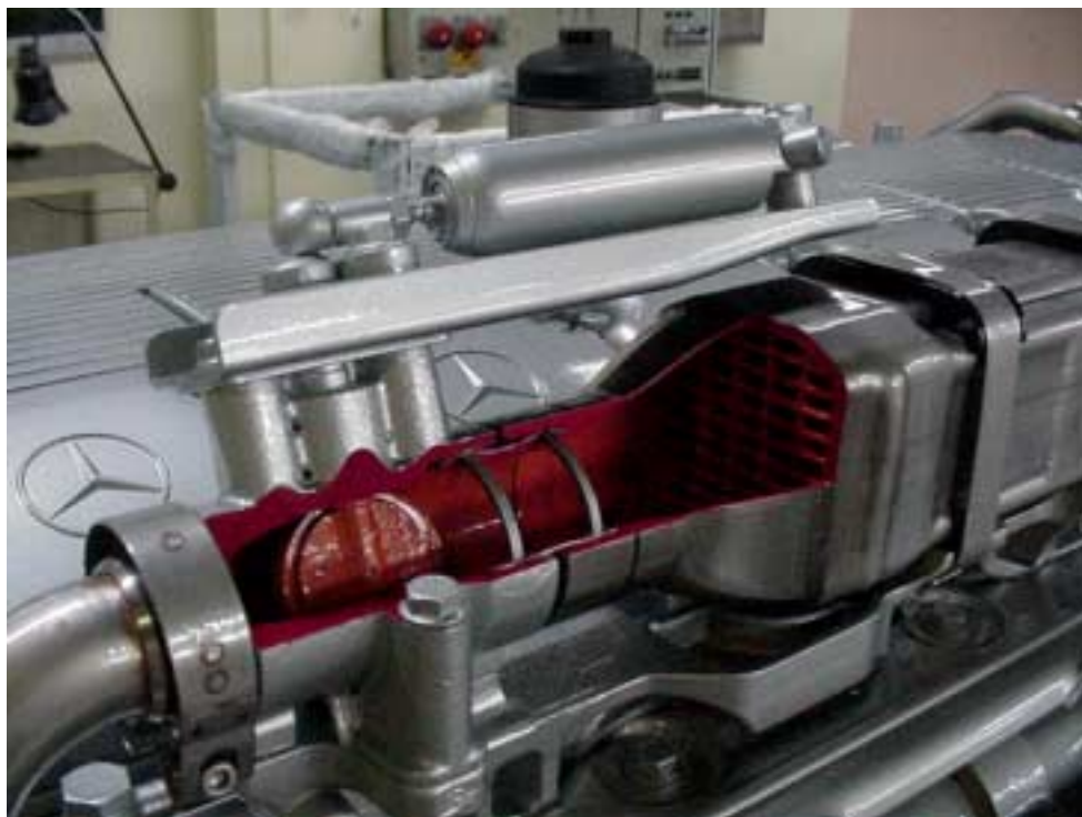
Figura 29 – Válvula de controle de pressão para freio motor (shut off)
