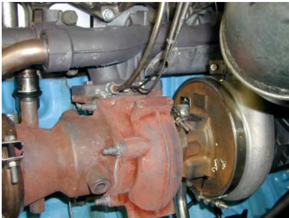
Figura 45 – Pontos de pressão e temperatura para controle dos gases de escape
