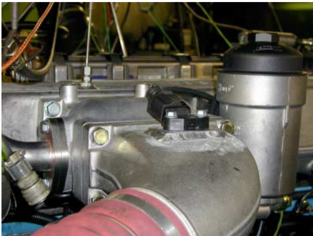
Figura 50 – Detalhe do sensor combinado na do ar de admissão para medição de temperatura e pressão
