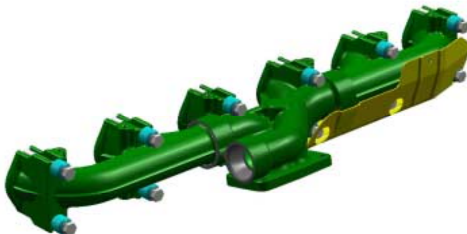
Figura 26 – Coletor de Escape para Turbina Assimétrica montado em 3 partes
