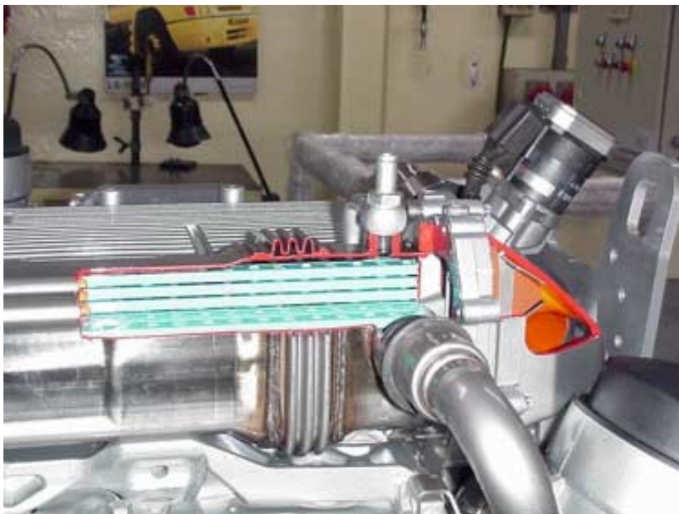
Figura 31 – Trocador de calor em corte e válvula controladora de EGR
