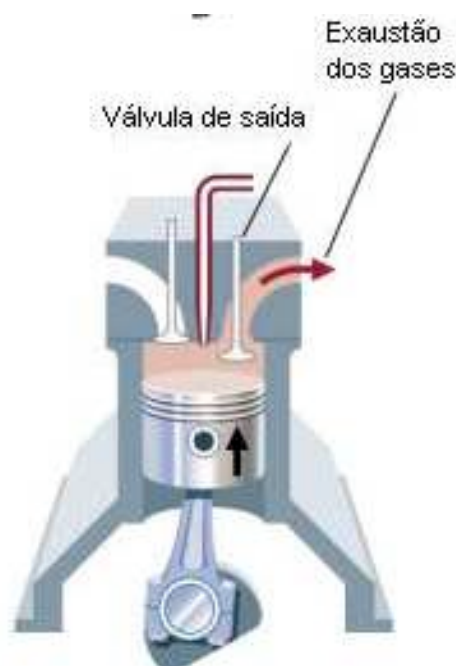
Figura 5 – Esquema ilustrativo do quarto tempo do motor Diesel a 4 tempos
