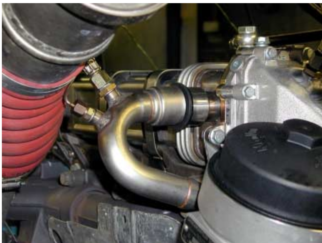
Figura 46 – Pontos de medição após o trocador de calor do EGR
