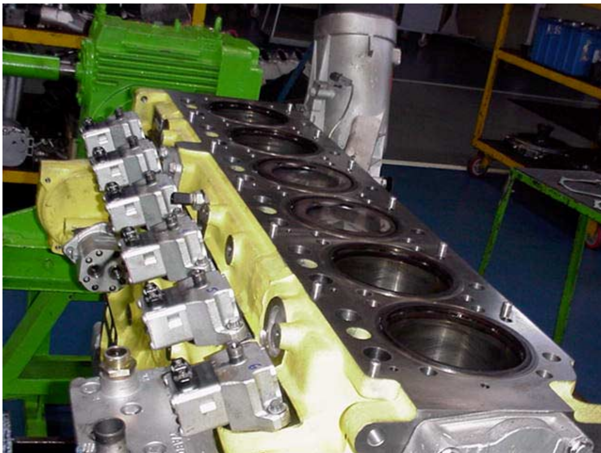
Figura 42 – Vista superior do bloco, mostrando as bombas individuais de combustível para o gerenciamento eletrônico de combustível Mercedes-Benz
