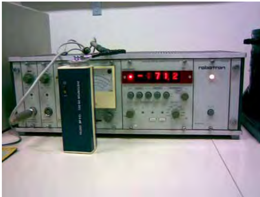
Figura 2.6 - Conjunto Pistofone – Estetoscópio e Condicionador de Sinal
