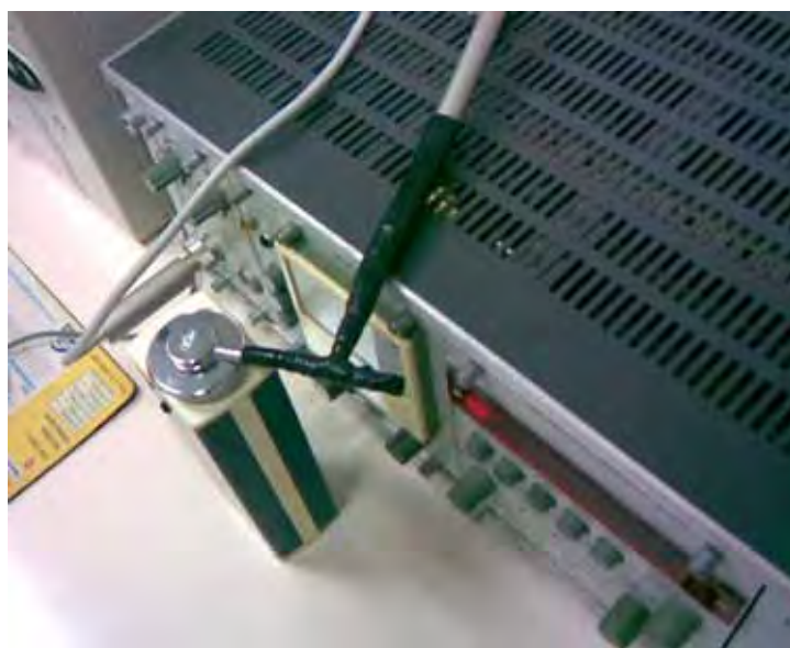
Figura 2.8 - Microfone acoplado ao estetoscópio
