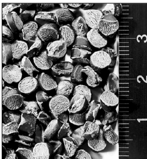
Figura 3.12 – Material granular utilizado por Fritz (2002) para a geração de ondas de deslizamento.
