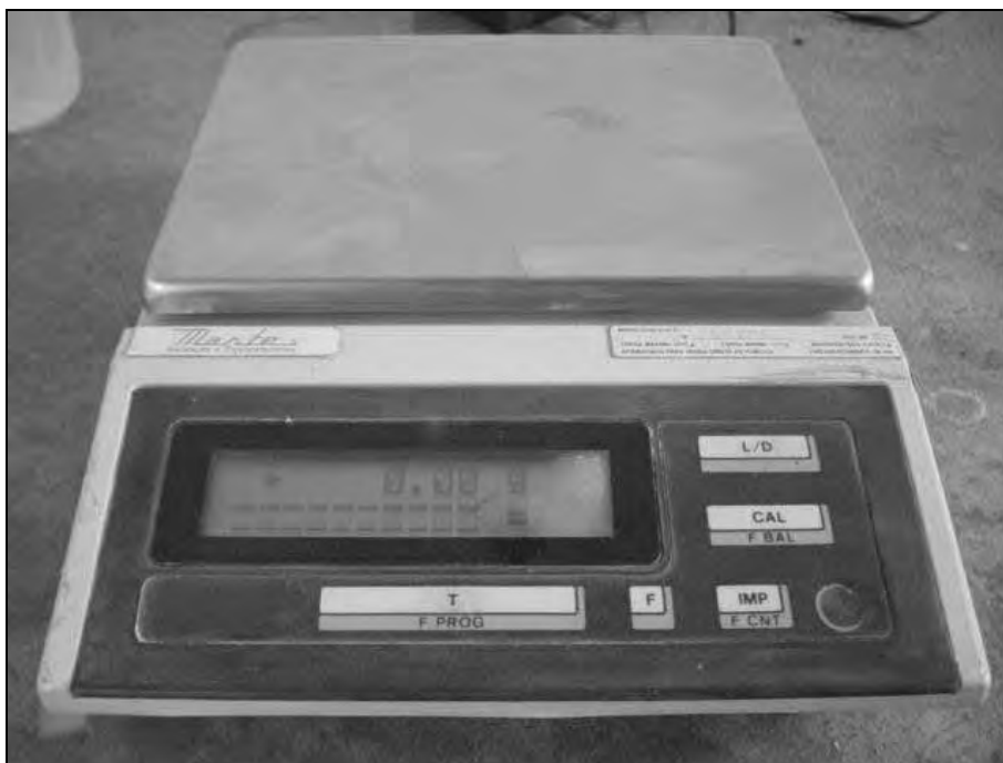
Figura 4.13 – Balança digital utilizada para medir a massa das amostras.
