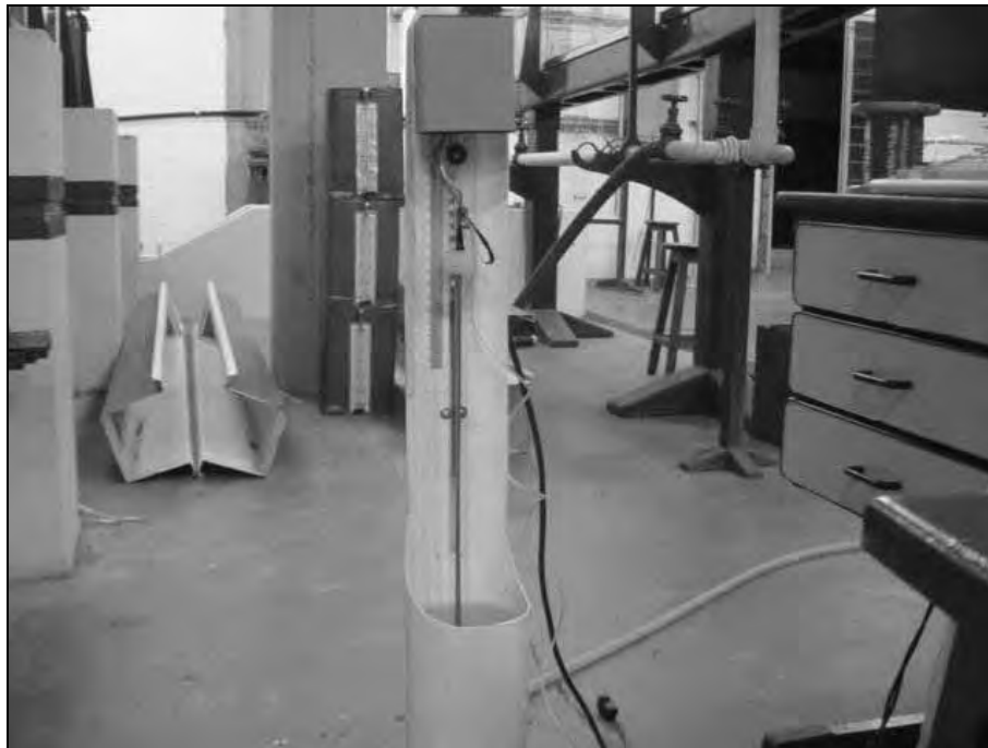
Figura 4.9 – Tubo graduado utilizado para calibração das Sondas.
