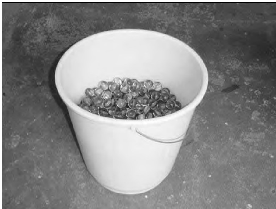
Figura 4.15 – Esferas de vidro utilizadas para a geração de ondas.
