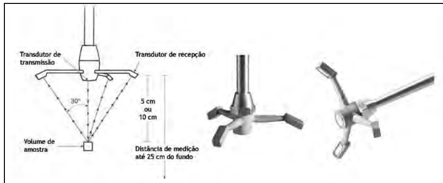
Figura 4.17 – Sensores piezo-elétricos da sonda ADV que permitem a medição da Frequência nas três direções.
