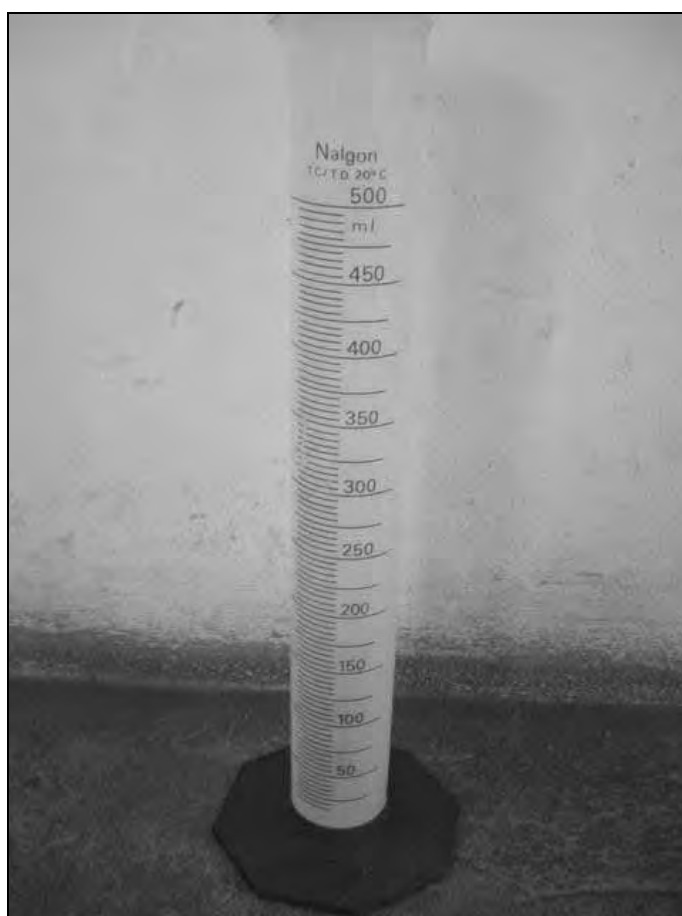
Figura 4.14 – Proveta graduada utilizada para medir os volumes deslocados das amostras.
