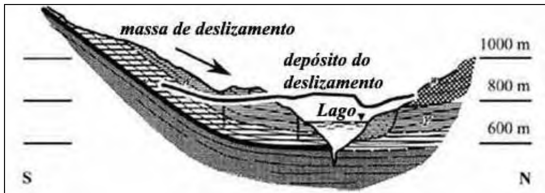
Figura 1.2 – Seção transversal e deslizamento do Vale Vajont (Itália). Adaptado de FRITZ, 2002.
