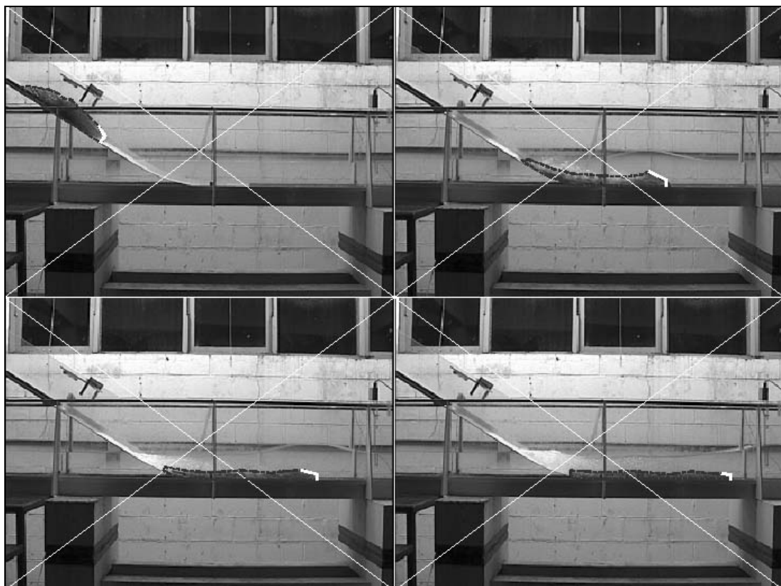
Figura 4.24 – Evolução da geometria da frente de material granular em quatro posições distintas.
