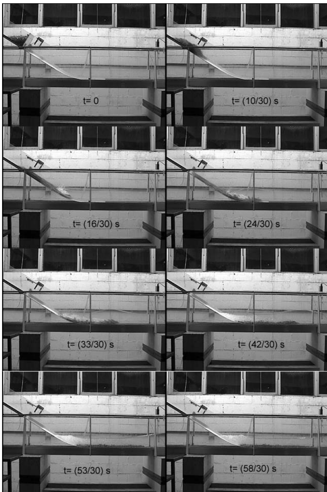
Figura 5.3 – Geração de ondas com o deslizamento de esferas de vidro. Lâmina d'água de 17,5 cm (ensaio 13).
