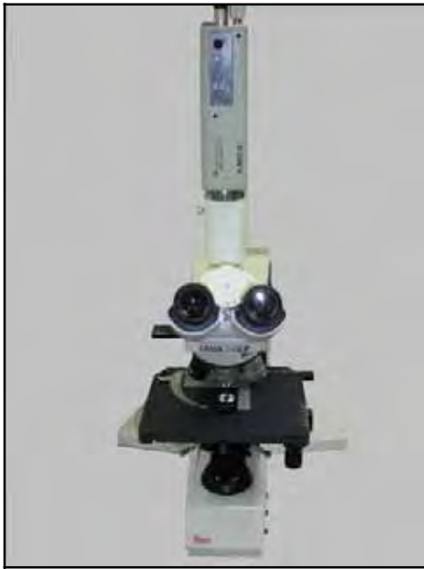
FIGURA 17-A: Microscópio Leica® de luz polarizada com câmera de captura Sony®.
