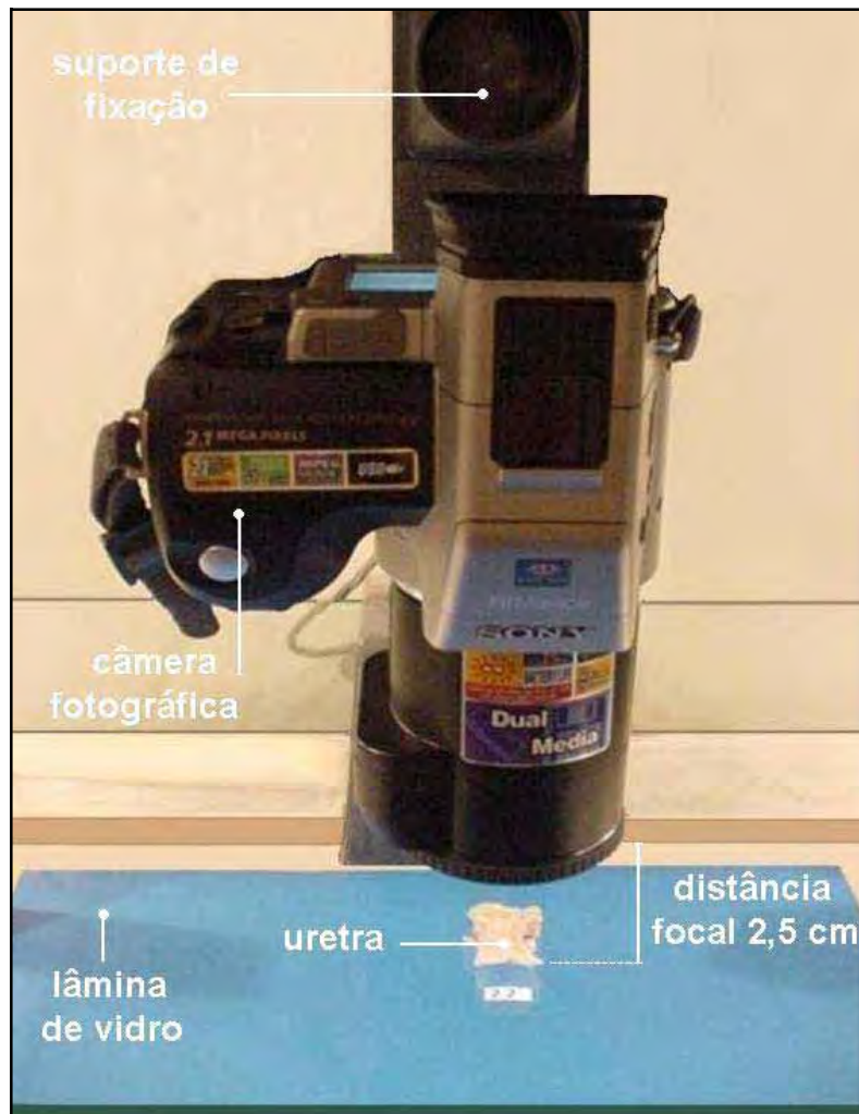
Figura 11: Sistema de digitalização de imagem utilizado: câmera fotográfica digital Sony® com distância focal padronizada de 2,5 centímetros.
