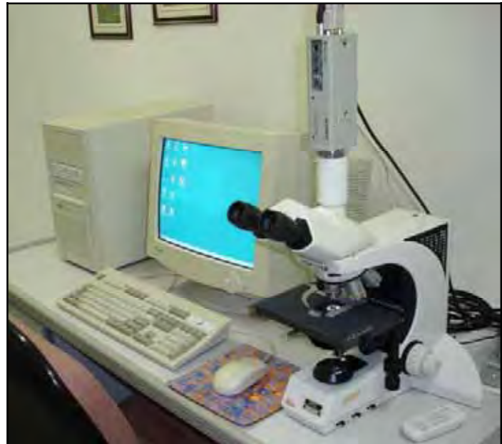
FIGURA 17-B: Sistema de captura utilizado no processamento de imagens.
