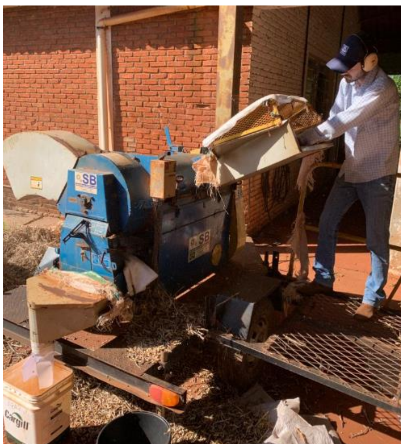
Figura 9. Equipamento utilizado para abertura das vagens – trilhadora de grãos
