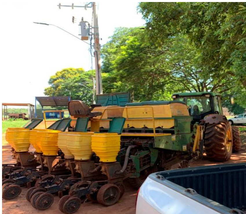
Figura 2. Semeadora-adubadora utilizada na instalação do experimento
