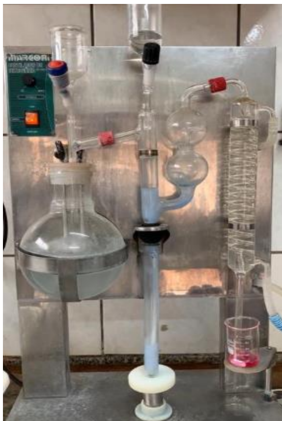
Figura 14. Equipamento utilizado para determinação dos teores de nitrogênio
