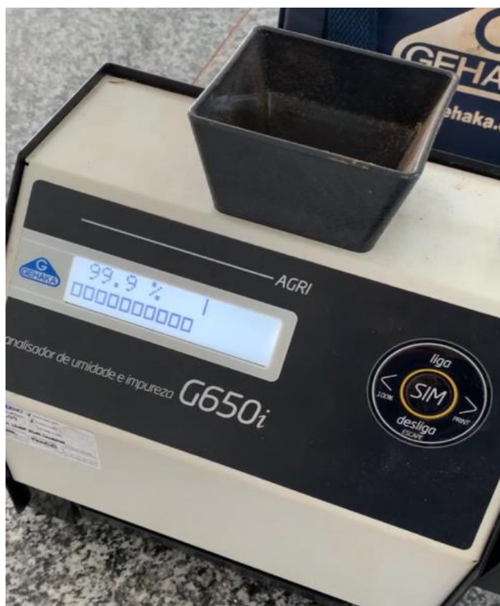
Figura 12. Equipamento utilizado para aferição da umidade dos grãos
