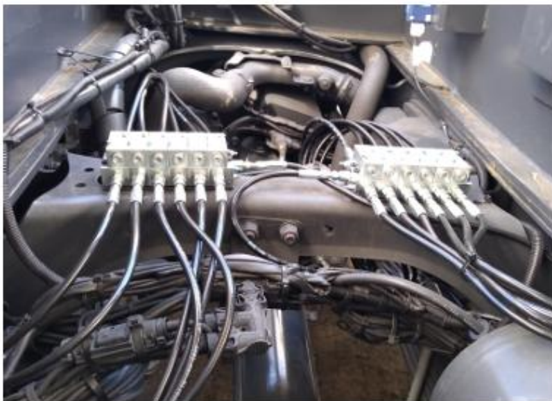
Figura 33 – Sistema de distribuição de graxa progressivo.
