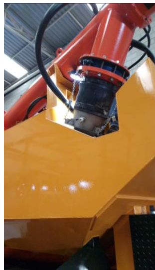
Figura 73 – Posicionamento duto de saída do transportador superior.
