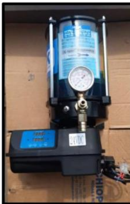
Figura 32 – Bomba para lubrificação do SECAMS.
