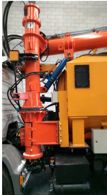
Figura 72 – Posicionamento transportador vertical e cilindros hidráulicos.
