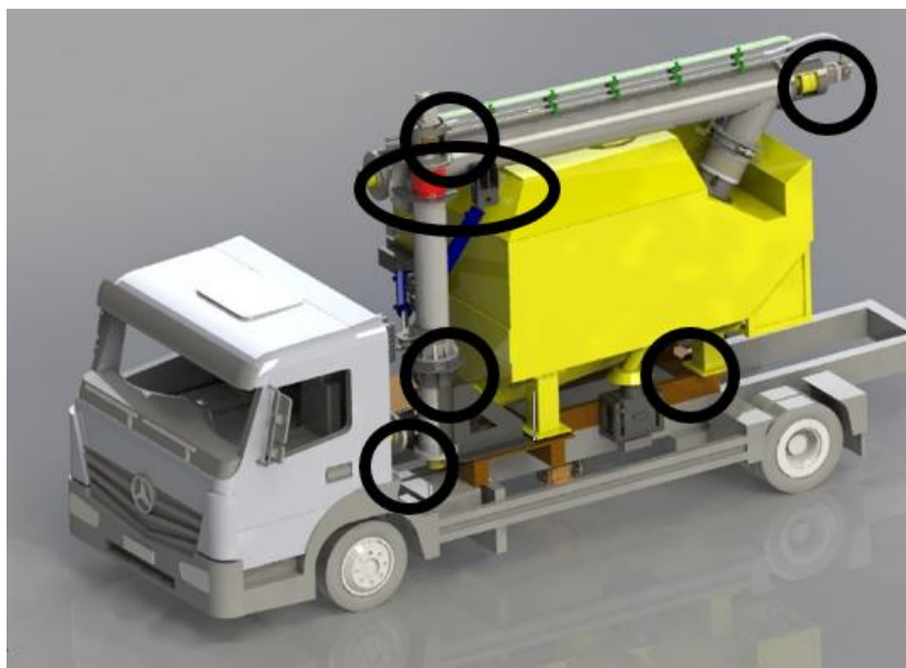
Figura 34 – Pontos de lubrificação automático no sistema.
