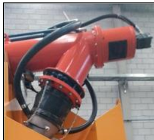
Figura 30 – Estrutura de montagem do sistema de descarga.
