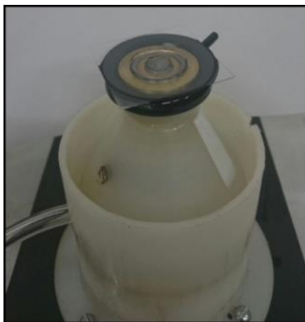
Figura 34 - Formação de partículas de desgaste sobre a lamínula.
