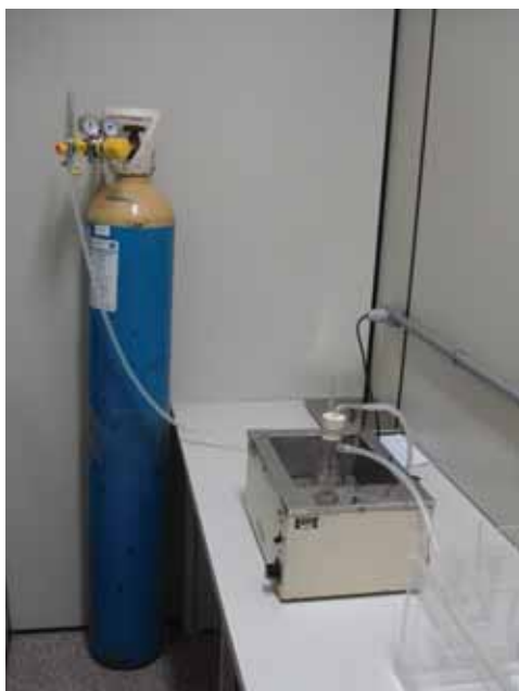
Fig 1. Cilindro de ar sintético acoplado às mangueiras e ao Kitassato, dentro do banho-maria, onde o ar será umidificado.
