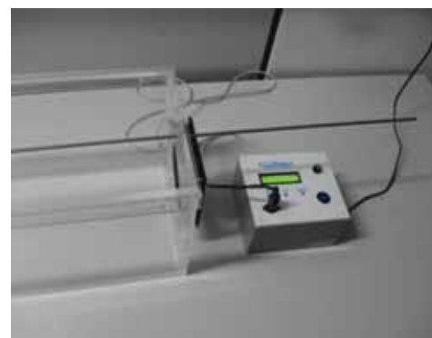
Fig 8. Exaustor-extremidade posterior do túnel.
