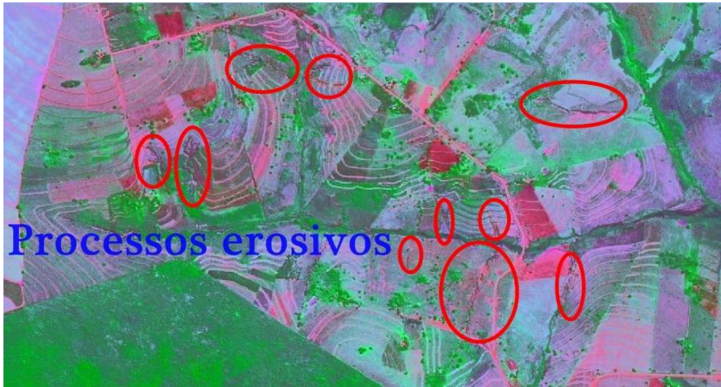
Figura 189: Encadeamento de processos erosivos. Fonte: Imagem satélite ALOS (Fusão) 2007/2008 – GADIS.
