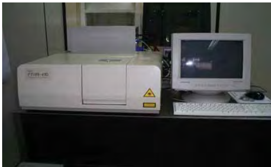
Figura 14: Foto do espectrômetro de absorção no infravermelho com transformada de Fourier, modelo Jasco FTIR-410.
