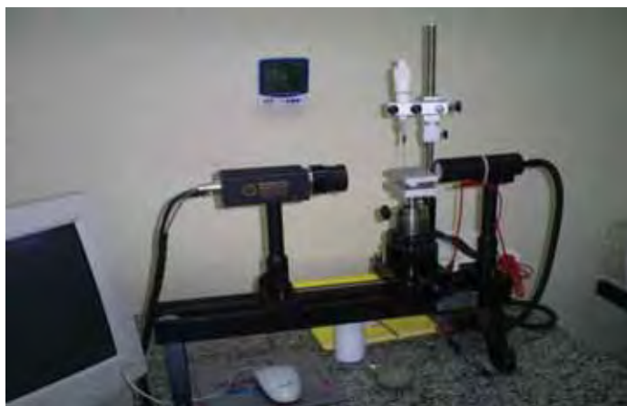
Figura 17: Ilustração do equipamento utilizado para as medidas de ângulo de contato.
