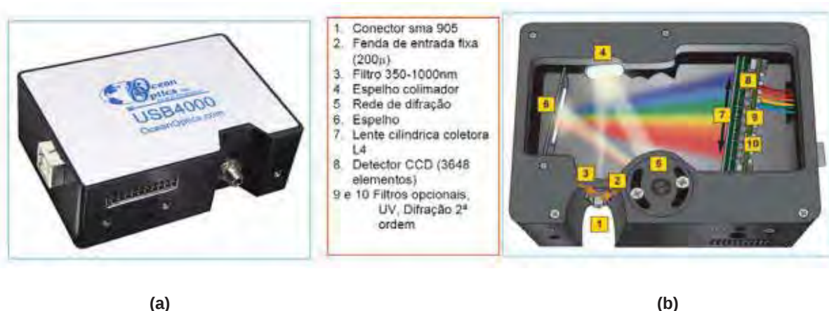
Figura 12: (a) Ilustração do espectrômetro modelo USB 4000 Ocean Optics e (b) ilustração da parte interna do espectrômetro.
