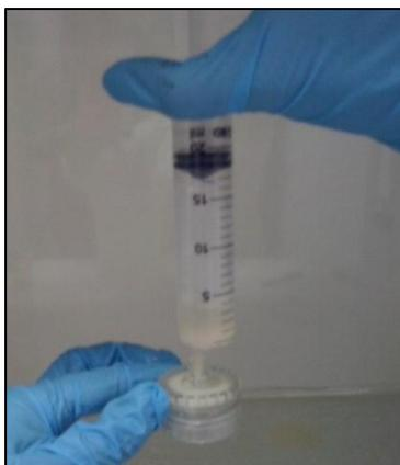
Figura 7: Filtragem dos discos após eluição em  $\text{HNO}_3$  1 mol  $\text{L}^{-1}$
