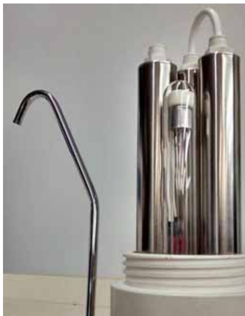
Figura 102 – Câmaras purificadoras implementadas, com detalhe de uma lâmpada UV inserida em tubo de quartzo
