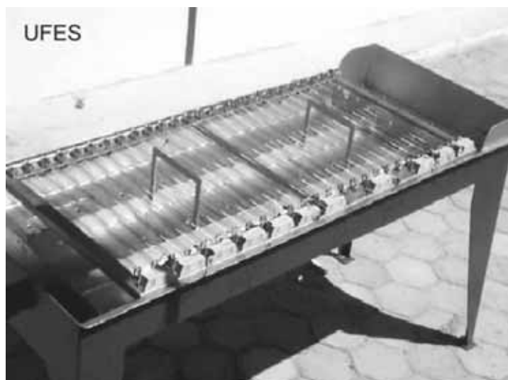
Figura 9 - Purificador UV com lâmpadas emersas, sem tampa de proteção dos canais de escoamento (pesquisa em pequena escala, UFES)
