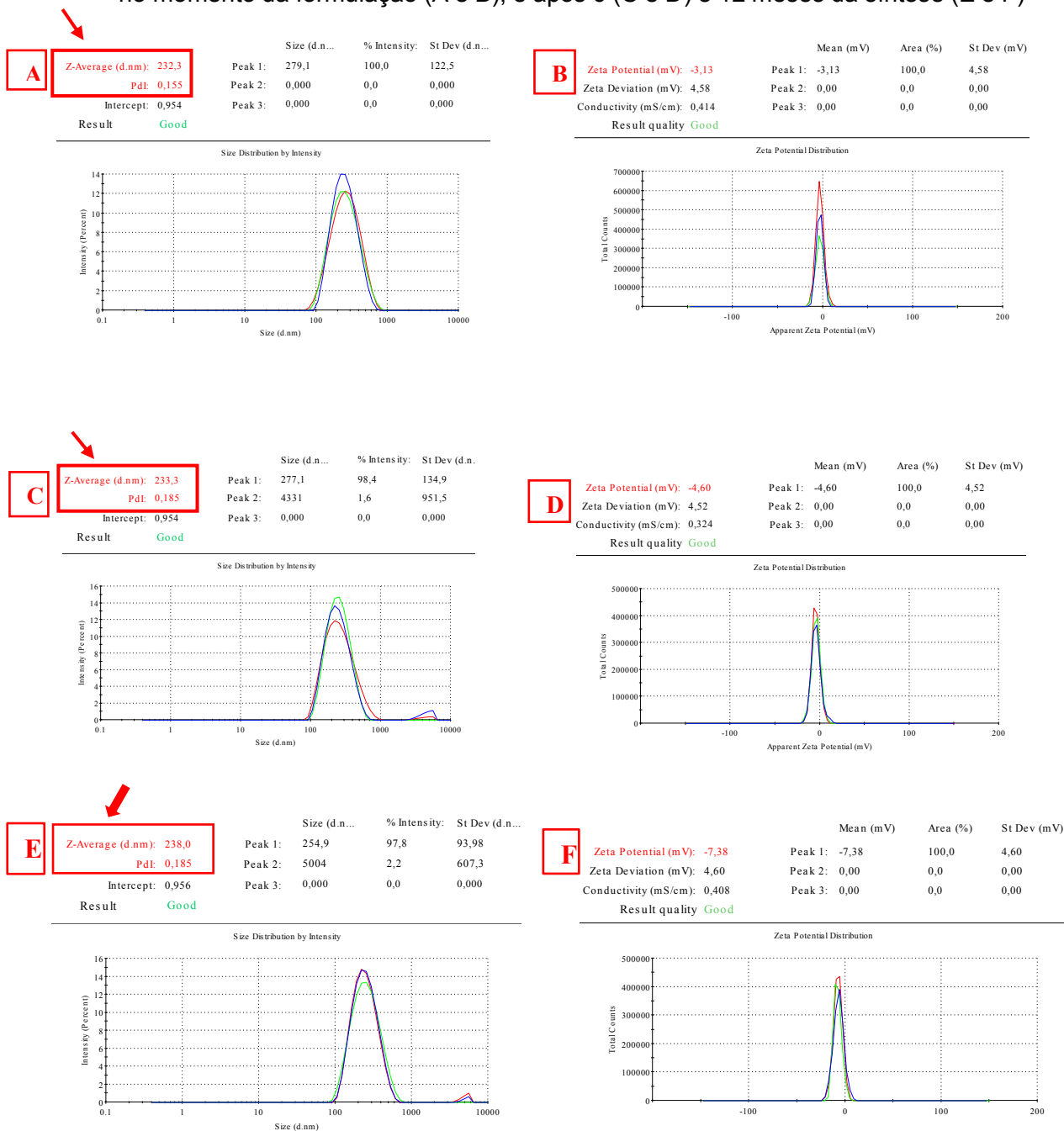
Figura 6 - Diâmetro médio do tamanho, PDI e potencial Zeta da NE incorporada com geraniol no momento da formulação (A e B), e após 6 (C e D) e 12 meses da síntese (E e F)
