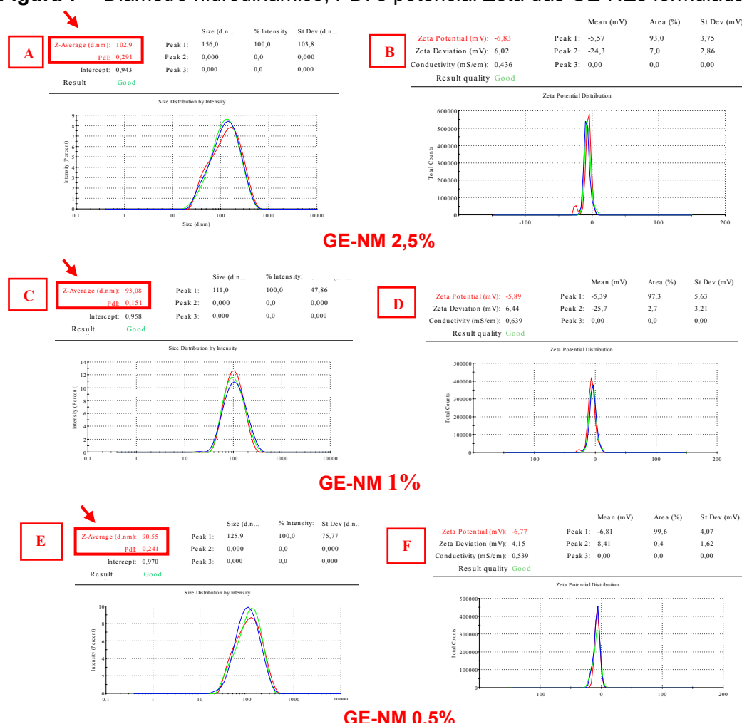
Figura 7 – Diâmetro hidrodinâmico, PDI e potencial Zeta das GE-NEs formuladas
