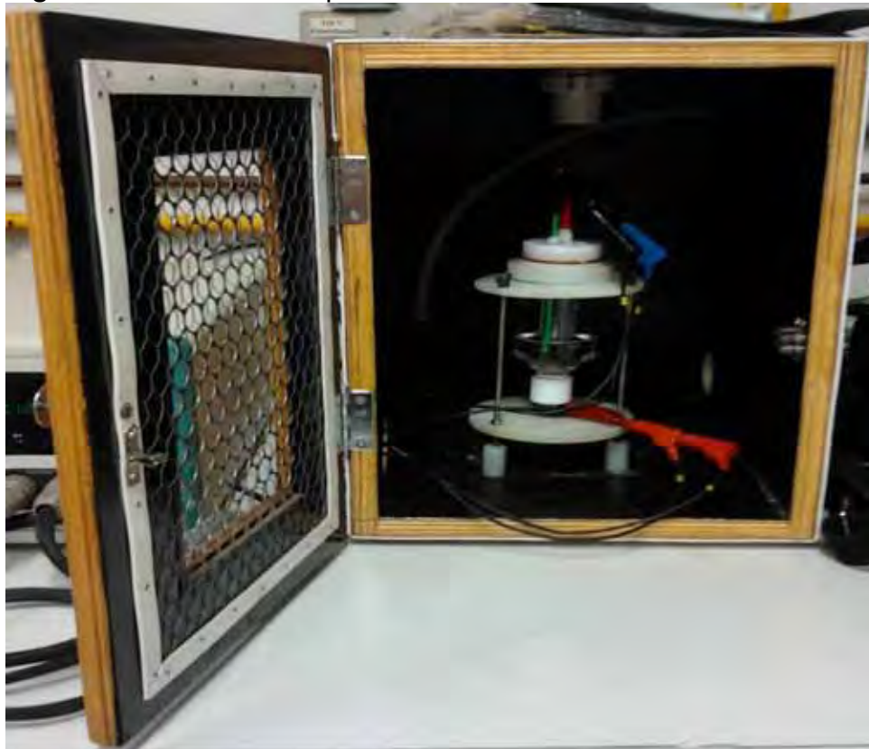
Figura 9 – Célula Eletroquímica com eletrólito e eletrodos conectados.
