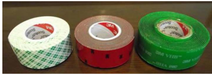
Figure 5.1: Fitas usadas no experimento, da direita para esquerda, Fita 113, Fita 4411 e Fita VHB 4910.
