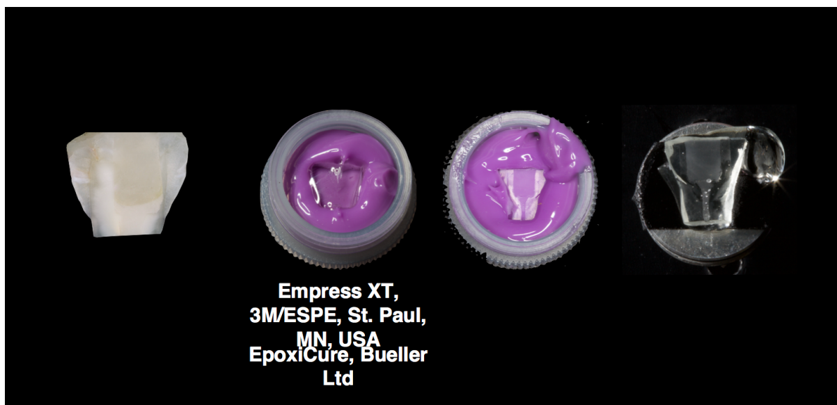
Figura A4 - Confeccção das réplicas em resina epóxi, das amostras que foram avaliadas no ensaio de adaptação interna.
