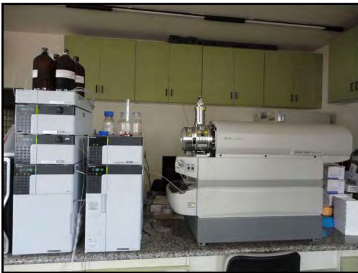
Figura 11. Cromatógrafo Líquido (Proeminence UFLC) acoplado ao espectrômetro de massas (3200 Q TRAP) – LC-MS/MS. Botucatu/SP, 2010.
