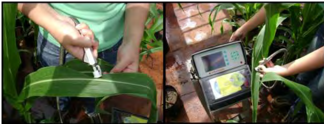
Figura 10. Detalhe da leitura do ETR em folhas de milho, com o fluorômetro portátil (OS5p). Botucatu/SP, 2010.
