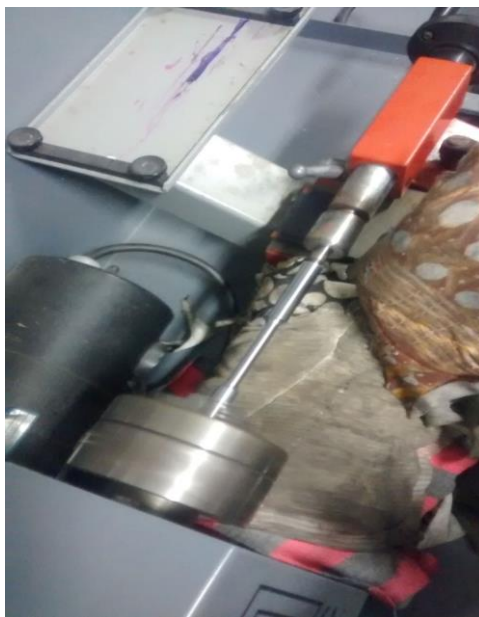
Figura 16 – Em um torno CNC e corpo de prova sendo lixado.
