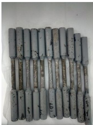
Figura 20- Corpos de prova após a limpeza da corrosão.
