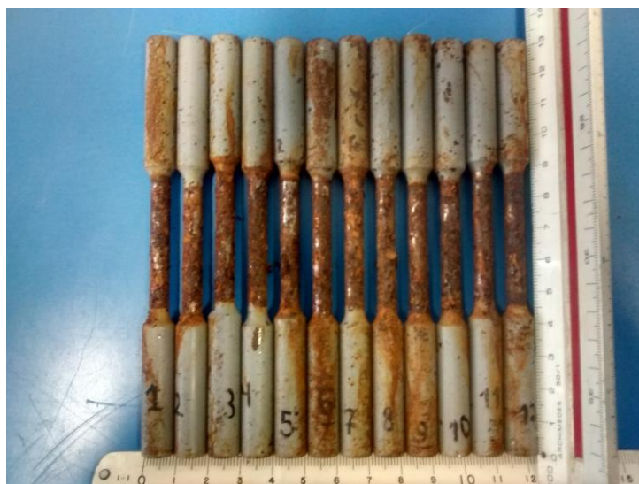
Figura 18 - Corpos de prova logo após a corrosão.
