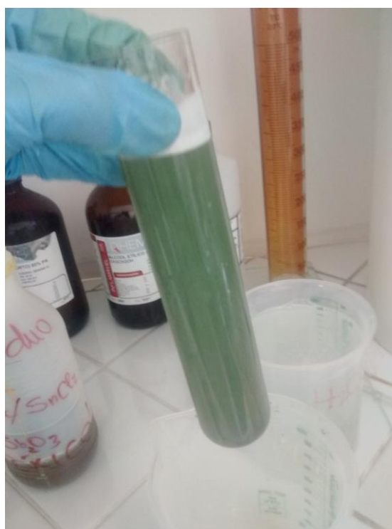
Figura 19 - Limpeza dos corpos de prova.
