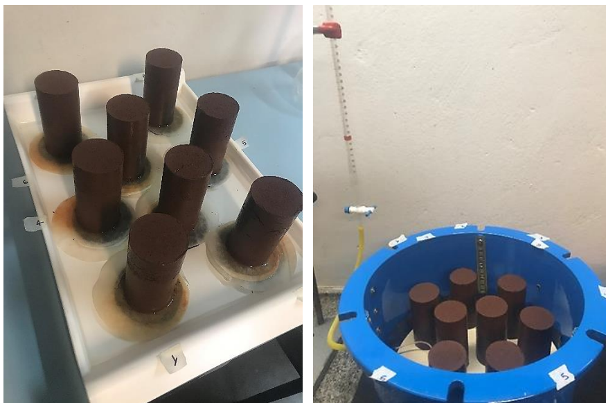
Figura 4.29: Saturação dos corpos de prova por capilaridade e imposição da sucção na câmara de Richards
