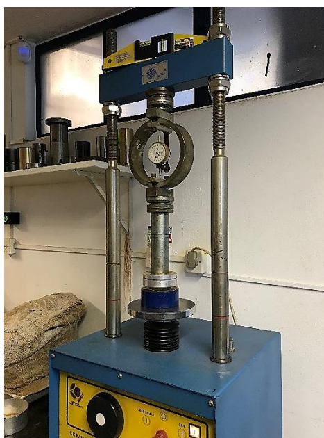
Figura 4.7: Equipamento utilizado na compactação estática dos corpos de prova para curva de retenção de água no solo
