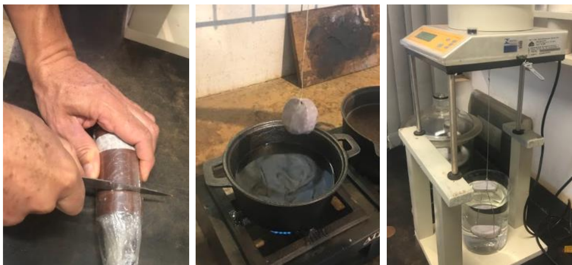
Figura 4.22: Obtenção da densidade aparente das camadas de solo do corpo de prova pelo método da parafina
