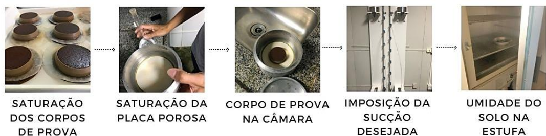
Figura 4.10: Esquema representativo dos procedimentos do ensaio de placa de sucção
