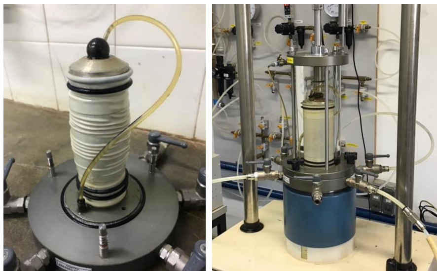
Figura 4.30: Montagem do corpo de prova na câmara triaxial utilizada em ensaios de compressão triaxial com controle de sucção
