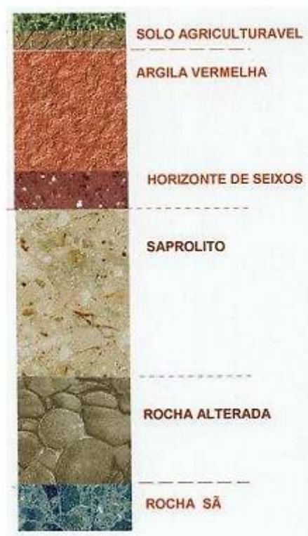
Figura 3.27: Perfil típico de solo na região da barragem de Itaipu (THÁ, 2007)
