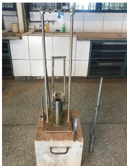
Figura 4.21: Equipamento utilizado na compactação dinâmica dos corpos de prova para ensaio de compressão triaxial
