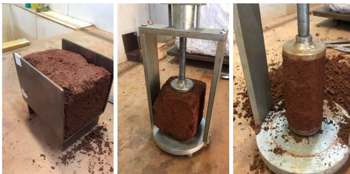
Figura 4.12: Moldagem dos corpos de prova de amostra indeformada para ensaio de permeabilidade
