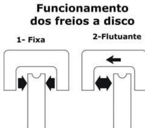
Figura 3.2 – Esquema de freio a disco
