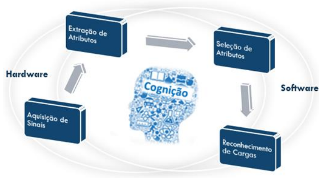
Figura 8 – Arquitetura do sistema cognitivo de medição de energia.
