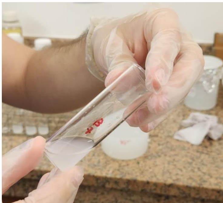
Figura 2. Impregnação de tubo de ensaio de fundo chato com 5mL de calda inseticida.
