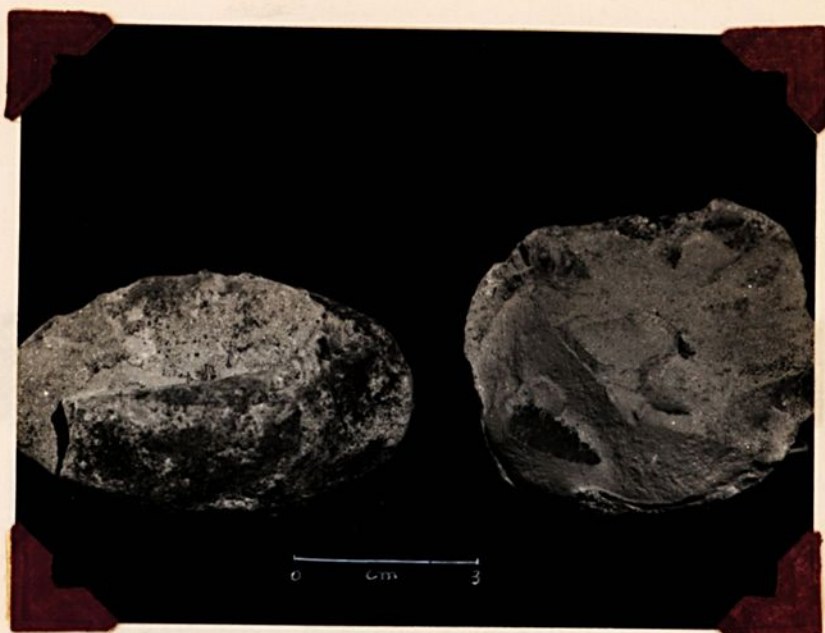
FOTO 4 - Seixos de argilito apresentando bom í ndice de arredondamento e de esfericida - de coletados em exposições nasproximida - dades de Neves Paulista.
