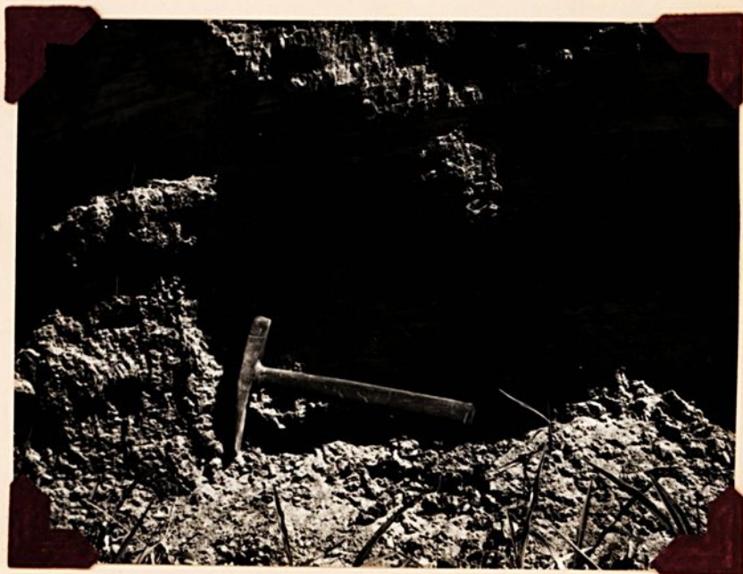
FOTO 5 - Arenito conglomerático com seixos de ar g ilito que acompanham a laminação (En tr a da de Neves Paulista).
