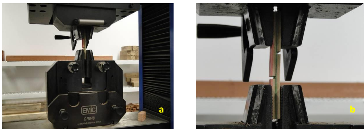
Figura 9 - Ensaio de cisalhamento dos corpos de prova retirados do shape.
