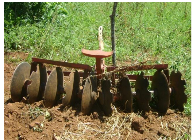
Foto 81 - Disco para aração do solo movido à tração animal (Família “F”, 2011)
