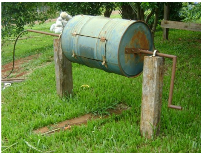
Foto 48 – Tecnologia apropriada utilizada para limpeza legumes: no orifício (centro da imagem) são inseridos, por exemplo, cenouras e beterrabas, os quais são higienizados pela entrada de água corrente à esquerda e o movimento do tambor acionado pela manivela, à direita, 2011.
