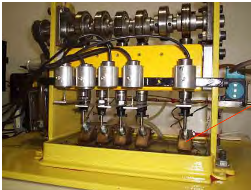
FIGURA 3 – Máquina de ciclagem, tendo 5 estações para o teste de fadiga.
