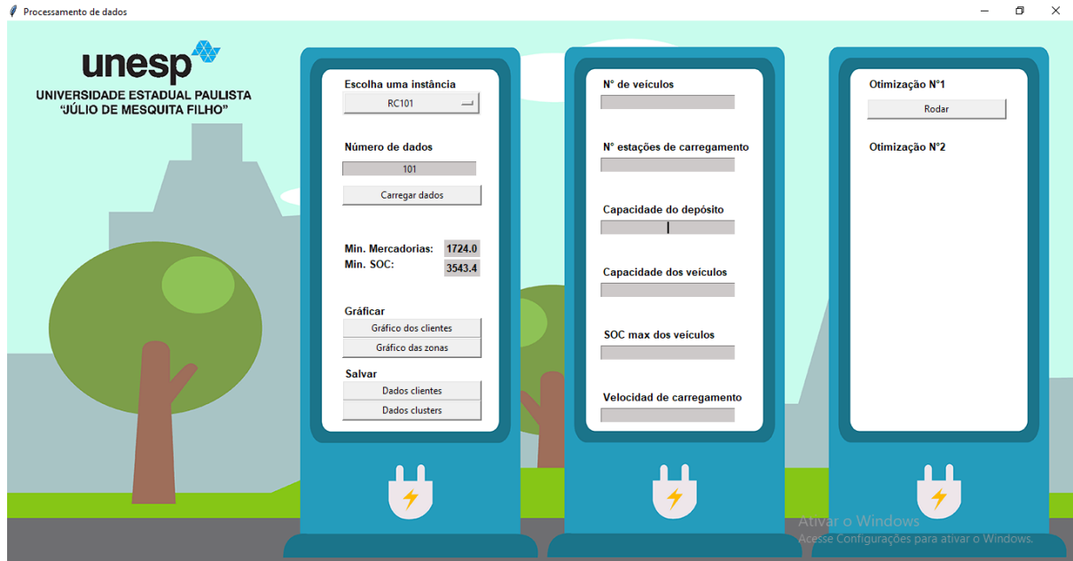
Figura 17. Interface Gráfica de Usuário (GUI) desenvolvida para o PRFVE.
