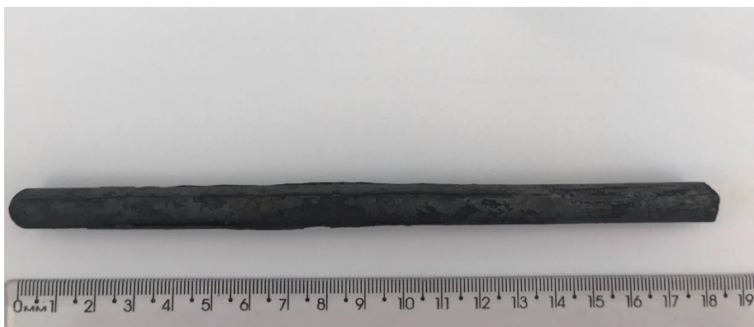
Figura 4 – Barras cilíndricas da liga Fe-35Mn obtidas após o forjamento a quente.
