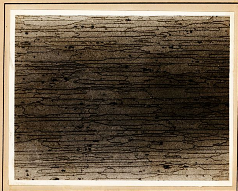
Fig. 4.2 Micrografia obtida por microscopia ótica, mostrando a estrutura de grãos no plano da espessura, no sentido da laminação da chapa na condição T761. Ataque \text{H}_3\text{PO}_4 . (250 x)
