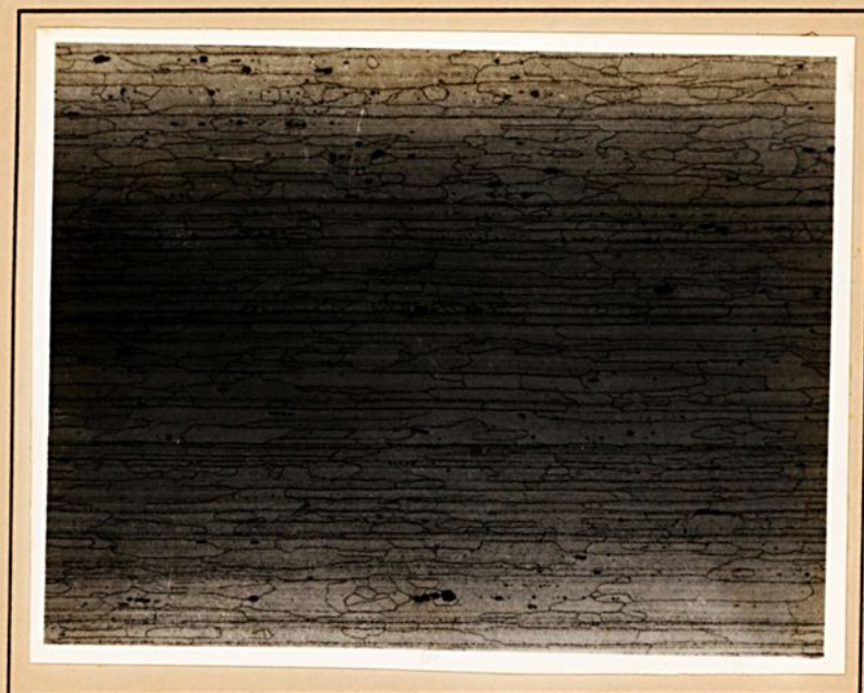
Fig. 4.4 Micrografia obtida por microscopia ótica, mostrando a estrutura de grãos no plano da espessura, no sentido da deformação da chapa na condição T761, deformada com 5,0 % após o pré-envelhecimento. Ataque H_3PO_4 . (250 x)
