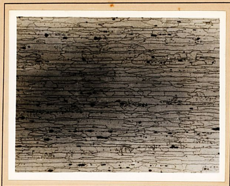
Fig. 4.5 Micrografia obtida por microscopia ótica, mostrando a estrutura de grãos no plano da espessura, no sentido da deformação da chapa na condição T761, deformada com 10,0 % após o pré-envelhecimento. Ataque \text{H}_3\text{PO}_4 . (250 x).
