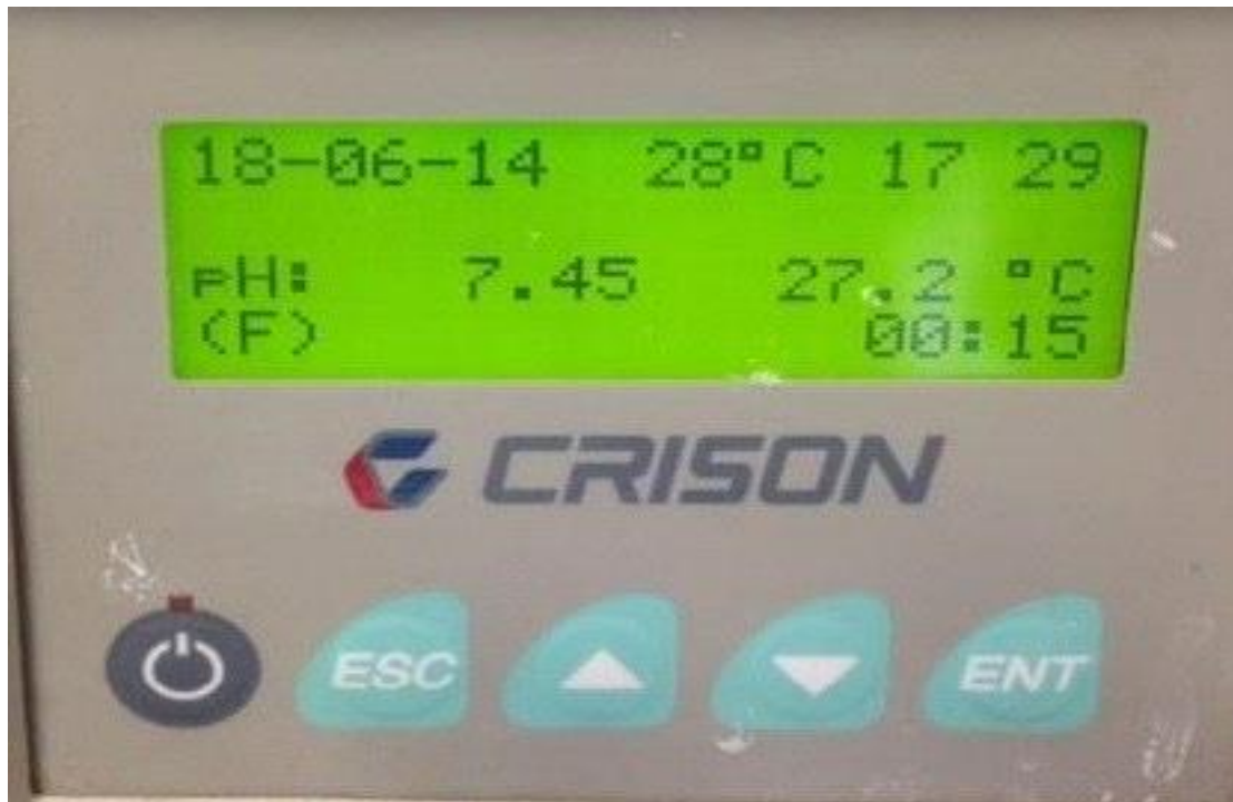
Figura 4: Valor do pH da solução de fluido corporal no phametro.
