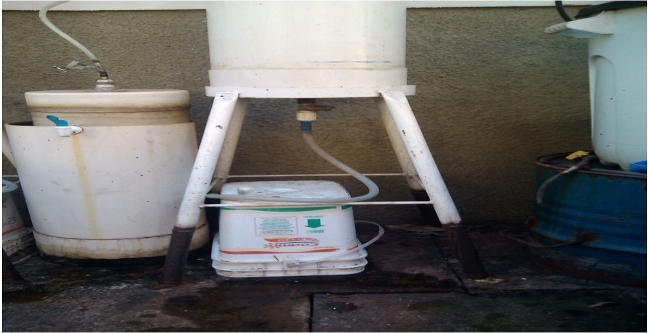
Figura 3. Vista da parte inferior do reator batelada com o registro de descarga. Fonte: o autor
