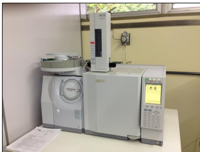
Figura 27. Cromatógrafo a gás (GC-MS) utilizado para a leitura das análises químicas realizadas na UFRGS.
