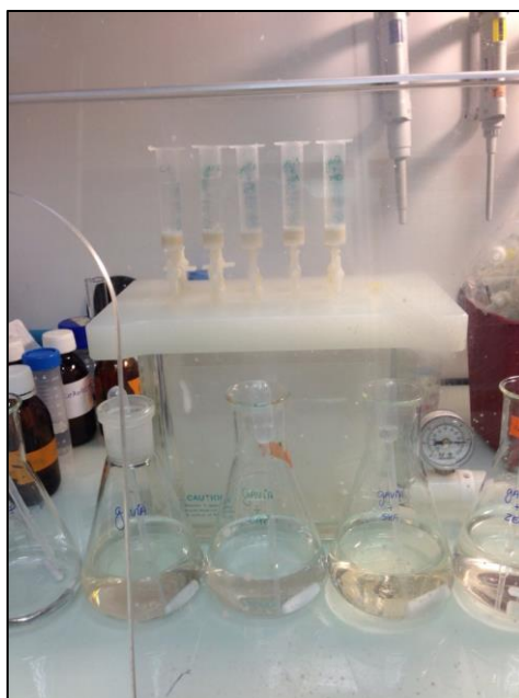
Figura 34. Bancada de trabalho da doutoranda em capela utilizada durante a realização do procedimento de SPE aplicado à amostras de água no INIA.
