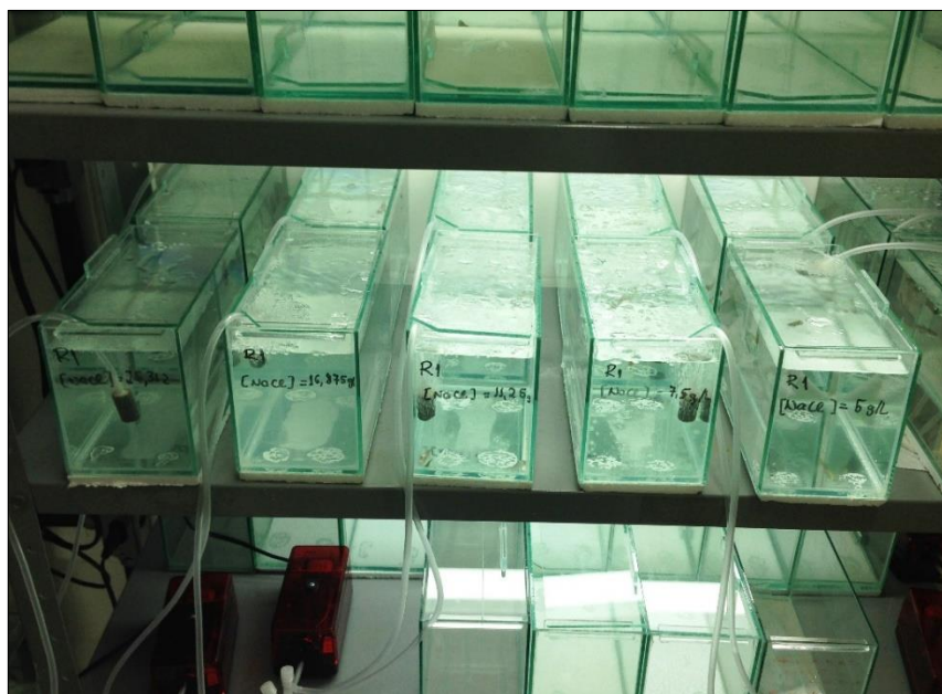
Figura 2. Disposição de um teste de sensibilidade de Danio rerio ao NaCl.
