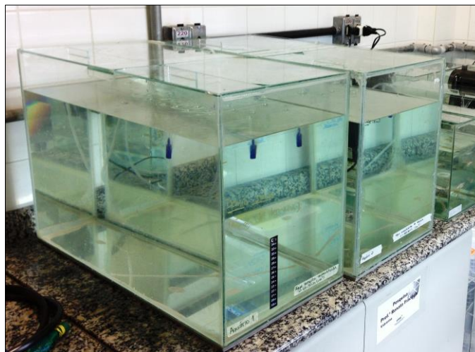
Figura 1. Aquários utilizados para o preparo e estocagem de água reconstituída (água de cultivo).
