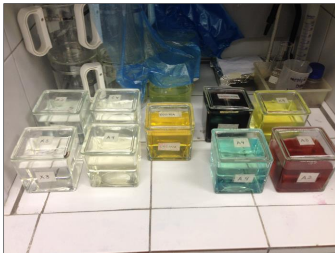
Figura 21. Bancada da capela preparada com a sequência de soluções utilizadas no protocolo de coloração histoquímica com vermelho neutro.
