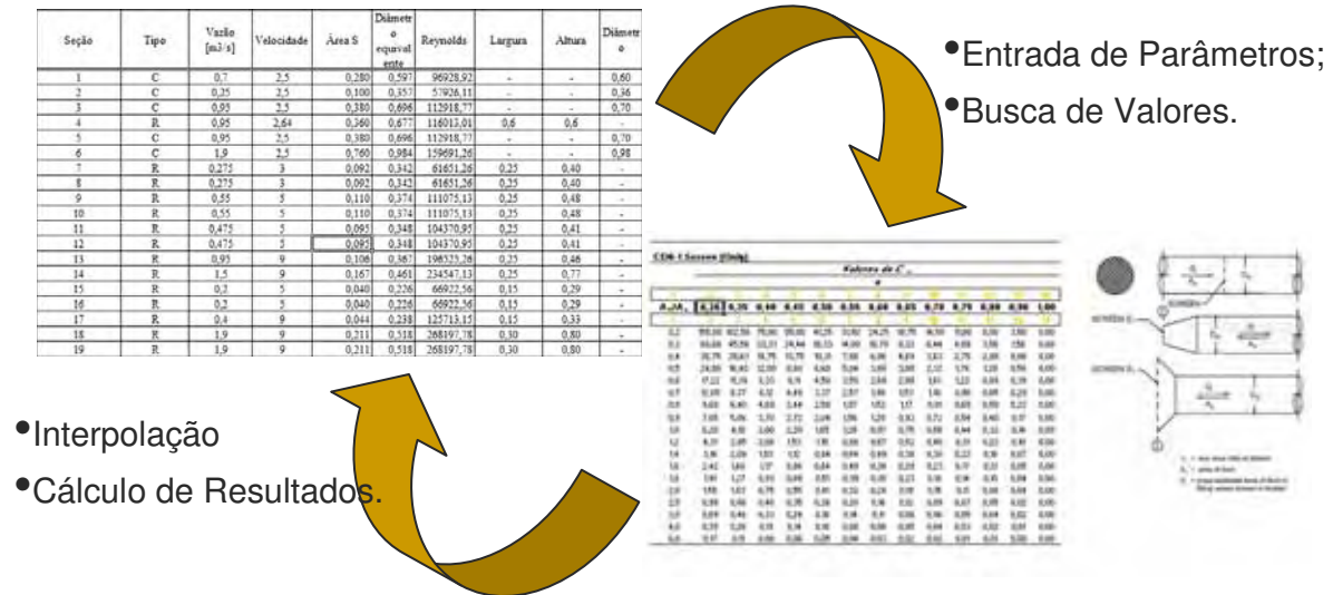
Figura 6 – Fluxo de interpolação e cálculo de coeficientes de perda localizada através de planilhas do Excel
