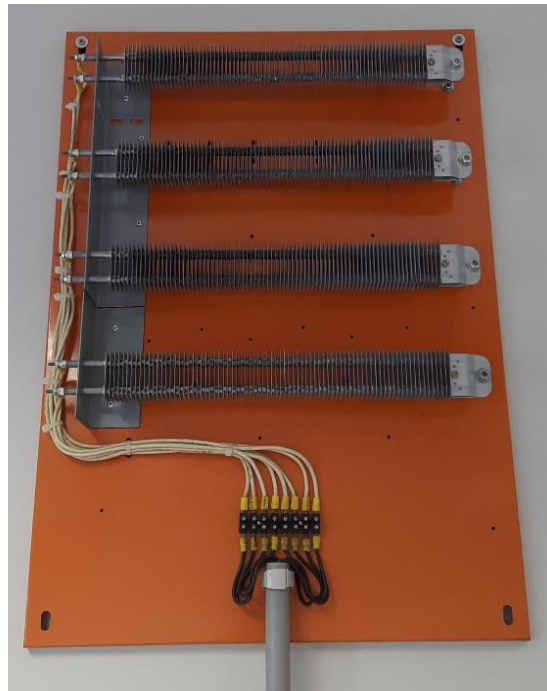
CARGA RESISTIVA Circuito de Armadura
