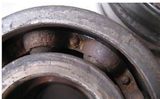
Figura 4 – Exemplo de oxidação nos rolamentos
