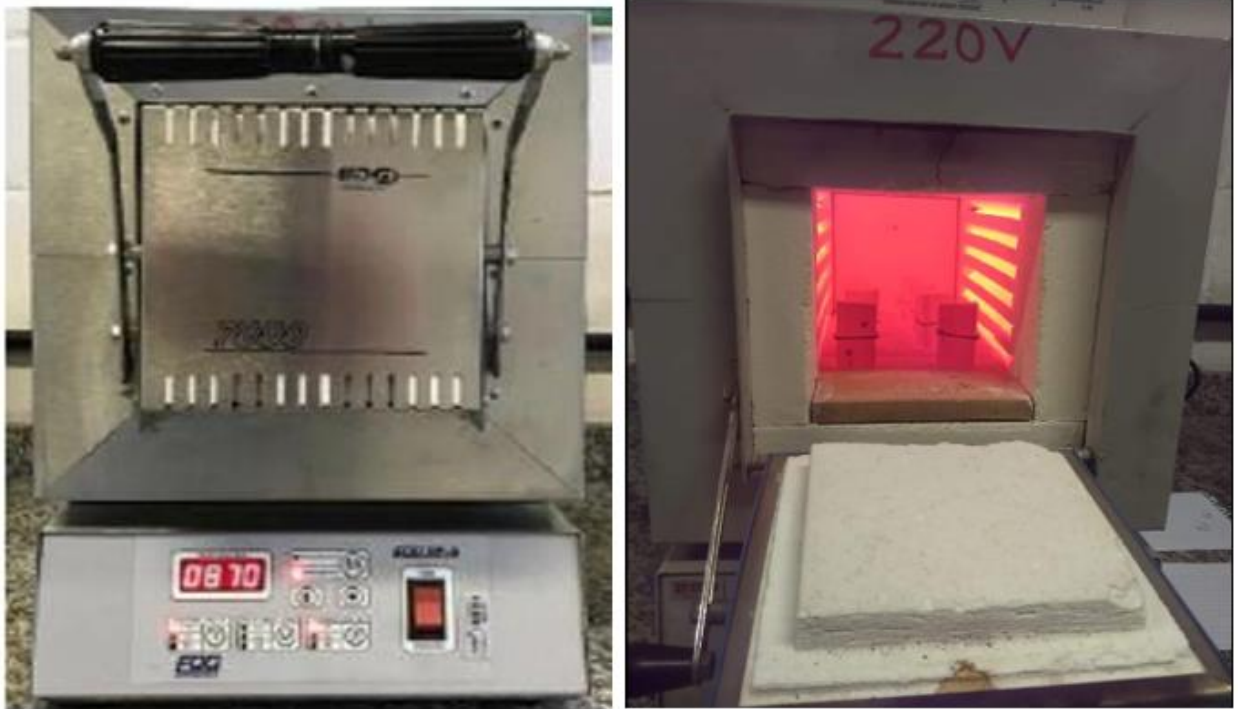
Figura 23 - Fornos utilizados para austenitização das amostras
