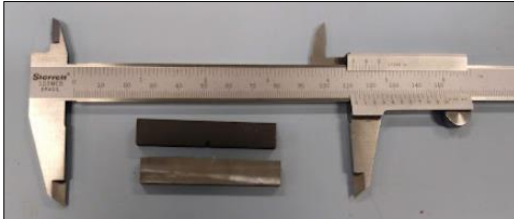
Figura 27 - Corpo de Prova confeccionado para elaboração do ensaio de Impacto
