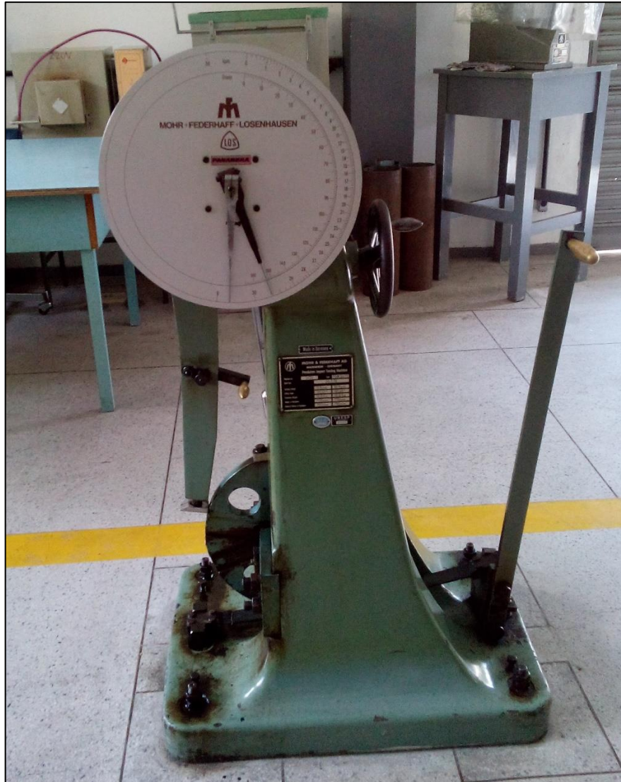
Figura 29 - Máquina utilizada no ensaio de impacto
